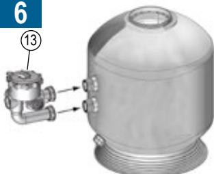
Mettre en place la vanne multivoies : placer d'abord la traversée basse puis la traversée haute. Serrer les écrous modérément.
