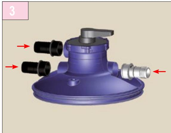
Collage des raccords sur le couvercle : Le raccord transparent côté sortie "égout", les raccords noirs ou gris côtés "entrée" et sortie "pompe".
