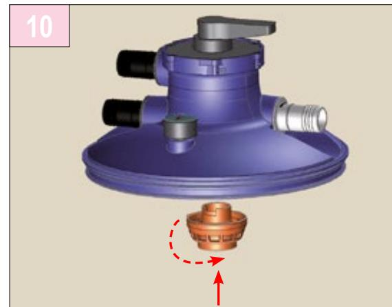
Mise en place du diffuseur : Centrer le diffuseur dans le logement, et le plaquer contre le couvercle, lui appliquer une rotation pour que la languette du diffuseur s'engage dans la rainure en U du couvercle, cela jusqu'à la butée.
