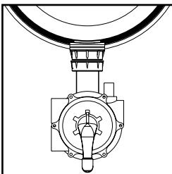
**FILTERING:** Gebruikelijke plaats van de klep. Het water dat van de pomp komt, gaat door de filter van hoog naar laag en keert terug naar het zwembad.
