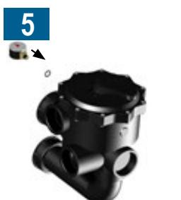
Garnir le filetage du manomètre de 4 tours de ruban Téflon et visser celui-ci sur la vanne multivoies à la place du bouchon.
