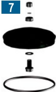
Montieren Sie das Entlüftungsventil auf den Deckel.
