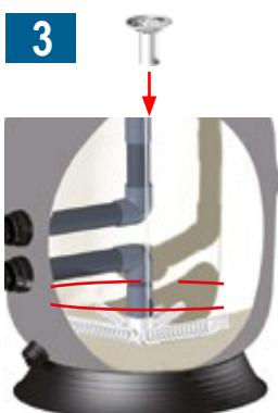
Verser la charge de sable (granulométrie 0.6/1.25) avec précaution afin d'éviter de casser les crépines. Retirer l'adhésif et remettre le diffuseur.
