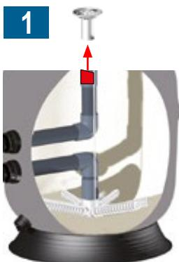
Retirer le diffuseur et boucher le tuyau à l'aide d'un ruban adhésif
