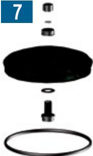
Mettre en place la purge haute sur le couvercle.
