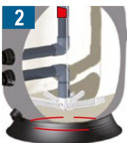
Controleer dat de ontluchter dicht is. Vul met water tot 5 cm boven de roosters.
