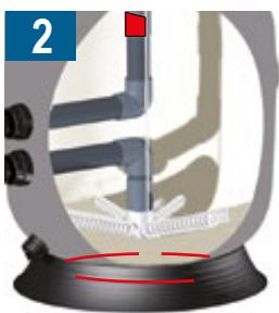
Stellen Sie sicher, dass das Entleerungsventil geschlossen ist. Füllen Sie die Pumpe mit Wasser, sodass die Saugrohre 5 cm unter der Wasseroberfläche liegen.
