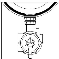
**FILTRATION** : Normale Ventilstellung. Das Wasser aus der Pumpe fließt von oben nach unten durch den Filter und kehrt ins Schwimmbecken zurück.
