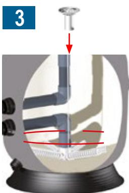
Giet er het zand voorzichtig in (korrelgrootte 0.6/1.25) om de roosters niet te beschadigen. Haal er de kleefband af en plaats de verdeler op zijn plaats.
