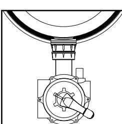
**REINIGEN :** Het water dat van de pomp komt, gaat door de filter van hoog naar laag en dan naar de afvoer.
