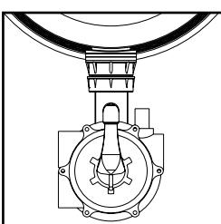
**WASSEN :** Het water dat afkomstig is van de pomp gaat door de filter van laag naar hoog en gaat dan naar de afvoer waardoor het vuil dat werd tegengehouden door de filter meegevoerd wordt.
