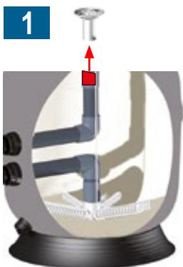
Entfernen Sie den Diffusor und decken Sie die Rohröffnung mit Klebeband ab.
