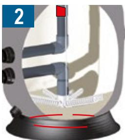
Vérifier que la purge de vidange soit fermée. Remplir d'eau à 5 cm au-dessus des crépines.
