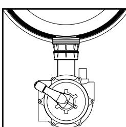
**GESCHLOSSEN** : Keine Wasserzirkulation. Die Pumpe darf auf keinen Fall betrieben werden, wenn das Ventil sich in dieser Position befindet.
