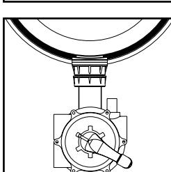
**SPÜLUNG** : Das Wasser aus der Pumpe fließt von oben nach unten durch den Filter und wird anschließend zum Ablass geleitet.
