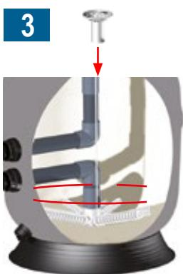
Füllen Sie vorsichtig den Sand ein (Korngröße 0,6/1,25), ohne die Saugrohre zu beschädigen. Entfernen Sie das Klebeband und bringen Sie den Diffusor wieder an.
