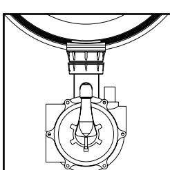
**RÜCKSPÜLUNG** : Das Wasser aus der Pumpe fließt von unten nach oben durch den Filter und wird anschließend zum Ablass geleitet. Dabei werden alle im Filter aufgefangenen Schmutzpartikel entsorgt.
