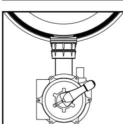
**KREISLAUF** : Das Wasser aus der Pumpe wird direkt ins Schwimmbecken zurückgeleitet, ohne durch den Filter zu fließen.
