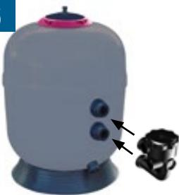
Bringen Sie das Mehrwegeventil an: Setzen Sie zuerst das untere, anschließend das obere Anschlussteil ein. Ziehen Sie die Sicherungsmuttern vorsichtig fest.
