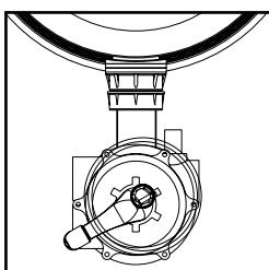
**ENTLEERUNG** : Das Wasser aus der Pumpe wird direkt zum Ablass geleitet, ohne durch den Filter zu fließen.
