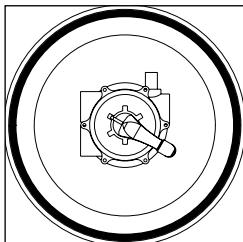
**NACHSPÜLEN :** Das von der Pumpe kommende Wasser fließt von oben nach unten durch den Filter und fließt durch den Ablass ab.
