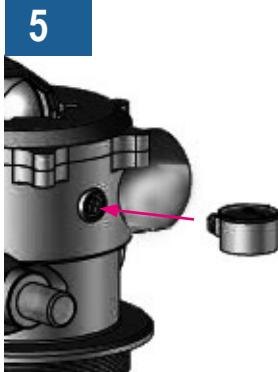
Wickeln Sie Teflonband um das Gewinde des Manometers und verschrauben Sie es mit dem Ventil. (Bitte keinesfalls zu fest anziehen, da Sie dem Ventil ansonsten irreparable Schäden zufügen könnten.)
