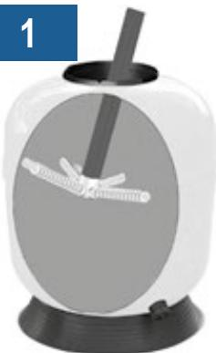
Stecken Sie das Sammelrohr in den Filtertank und schrauben Sie die Ansaugrührchen - nicht zu fest - an.
