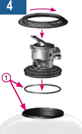
Passen Sie die Deckeldichtung Durchm. 230 X 8 (N° 11) in die Mulde am Deckel ein.
