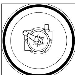
**GESCHLOSSEN :** Keine Wasserzirkulation möglich. Achten Sie darauf, dass die Pumpe in dieser Ventilstellung immer ausgeschaltet ist.
