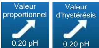
Lorsque le sens de dosage du pH est configuré en mode montant, ce bouton permet de choisir la valeur de la bande proportionnelle (si mode proportionnel choisi) ou la valeur d'hystérésis (si mode hystérésis choisi).
