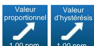
Lorsque le sens de dosage de la voie Chlore est configuré en mode montant, suivant le mode de régulation choisi précédemment, ce bouton permet de choisir la valeur de la bande proportionnelle ou la valeur d'hystérésis.
