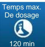
Ce bouton permet de saisir une durée quotidienne maximum d'injection de correcteur de pH. Cette durée max est configurable entre 0 (désactivé ou OFF) et 1440 minutes.
