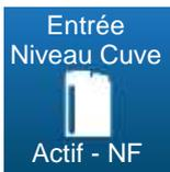
Ce bouton permet d'activer ou de désactiver l'entrée « fond de bac ». Il permet aussi de choisir le sens du contact NO ou NF.
