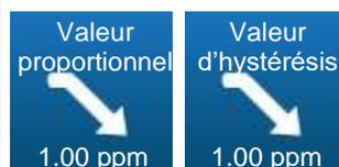
Lorsque le sens de dosage de la voie Chlore est configuré en mode descendant, suivant le mode de régulation choisi précédemment, ce bouton permet de choisir la valeur de la bande proportionnelle ou la valeur d'hystérésis.
