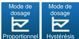
Ce bouton permet de choisir le mode de régulation du Rédox en mode proportionnel ou en mode hystérésis.
