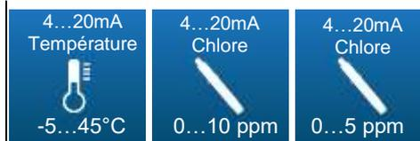
Ce bouton permet de dédier l'entrée 4...20mA soit à la température soit au Chlore 0...10 ppm ou 0...5 ppm.
