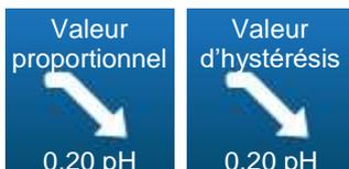
Lorsque le sens de dosage du pH est configuré en mode descendant, ce bouton permet de choisir la valeur de la bande proportionnelle (si mode proportionnel choisi) ou la valeur d'hystérésis (si mode hystérésis choisi).
