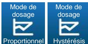
Ce bouton permet de choisir le mode de régulation de la concentration en Chlore en mode proportionnel ou en mode hystérésis.
