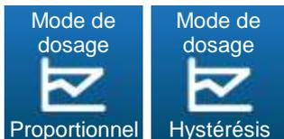
Ces boutons permettent de choisir le mode de régulation du pH : mode proportionnel ou mode hystérésis.
