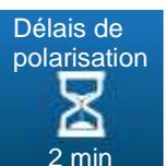
Ce bouton permet de saisir un délai d'attente avant prise en compte de la valeur délivrée par la sonde de pH, entre 0 et 480 minutes.
