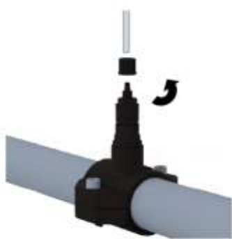
Dévisser l'écrou du clapet d'injection.
