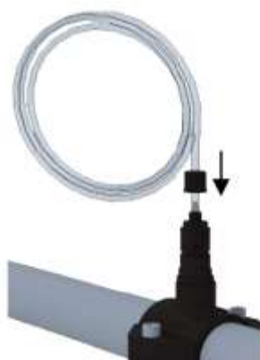
Passer le tube PE dans le bouchon et emmancher-le sur le cône du clapet.
