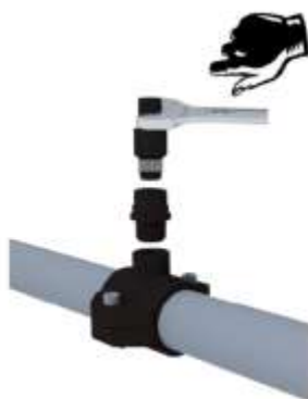
Visser le raccord sur le collier de prise en charge.
