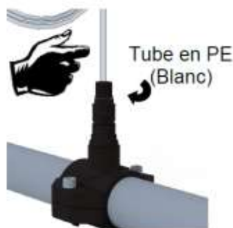
Visser le bouchon avec le tube PE (Blanc) sur le clapet.
