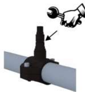
Serrer le clapet d'injection sur le raccord.
