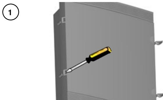
Entfernen Sie die Scharniere und Verriegelung
