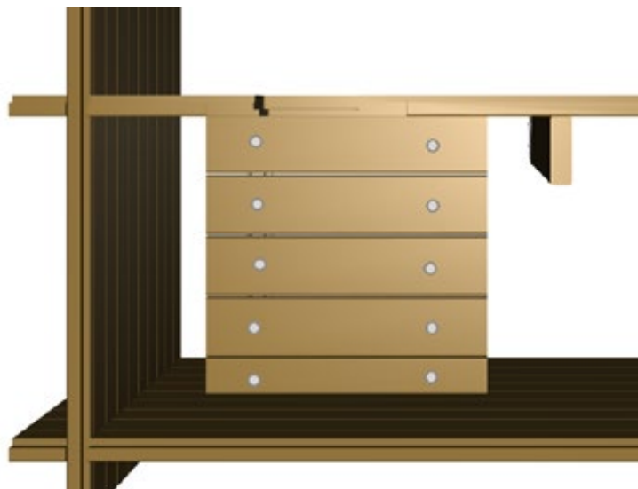
Figure 15 – Assemblage du fond de coffre
