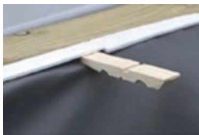
Abbildung 28 – Verklebung der Folienauskleidung mithilfe der halben Wäscheklammern
