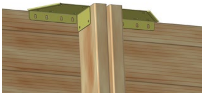
Abbildung 18 – Platzierung der Handlaufeckwinkel auf den Streben
