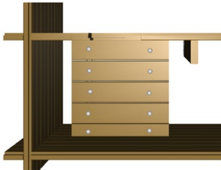
Figura 15 – Instalación del suelo de la caja
