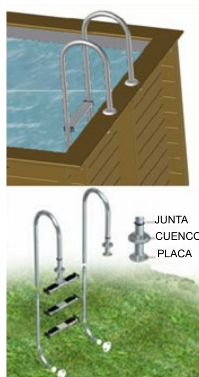
Figura 36 – Instalación de la escalerilla
