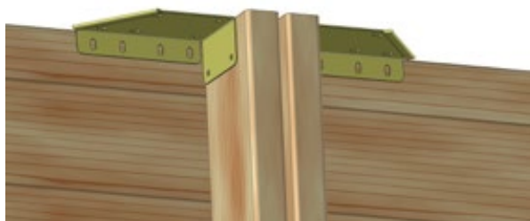
Figura 18 – Colocación de las escuadras de coronamiento en la parte superior de los puntales
