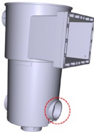
Figura 22 – Instalación de la calza sobre el skimmer
