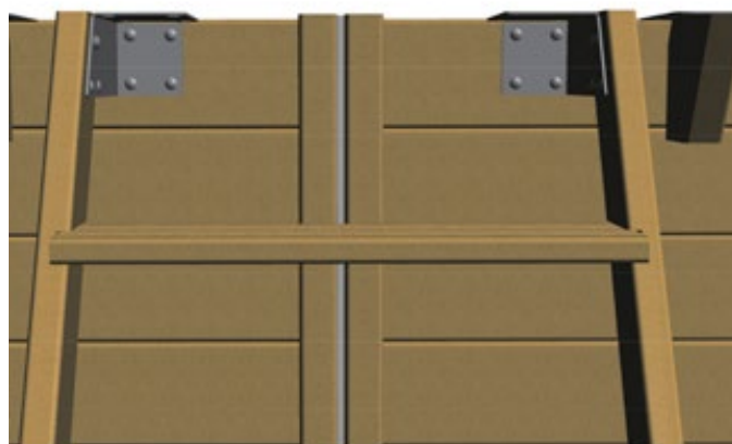
Figure 18 – Fixation de l'escalier extérieur sur le bassin
