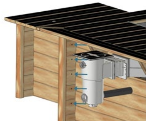
Figure 64 – Fixation du coffre sur le bassin
