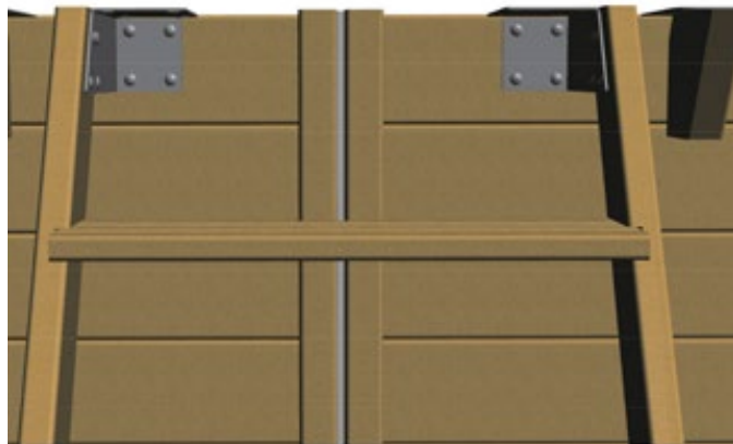
Abbildung 18 – Anbringen der Außenterrasse am Becken
