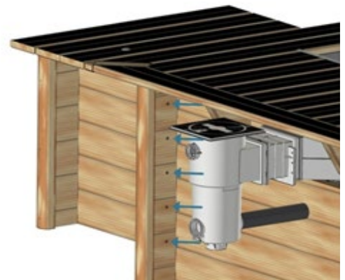
Abbildung 65 – Befestigung des Motorschachts am Pool
