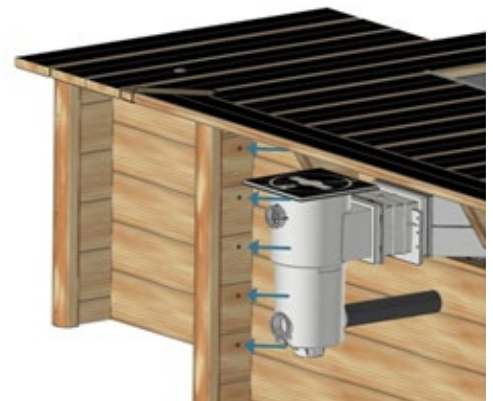
Figura 64 – Fijación del cofre sobre el vaso
