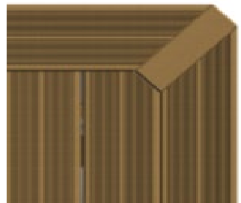
Figura 63 – Rastrel de la esquina del vaso
