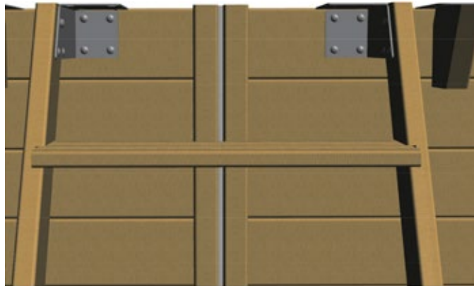
Figura 18 – Fijación de la escalera exterior sobre el vaso
