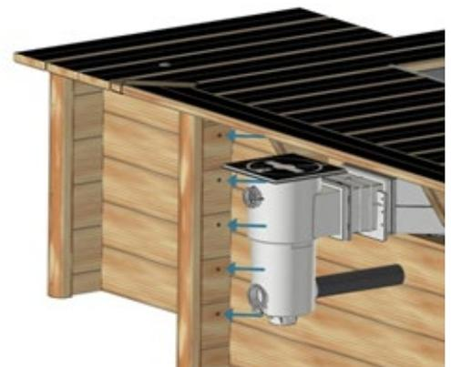
Figura 65 – Fissaggio del vano tecnico sulla vasca
