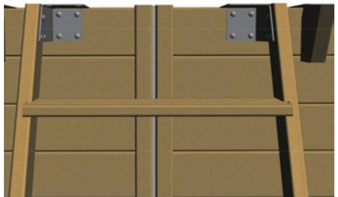
Figura 18 – Fissaggio della scala esterna sulla vasca
