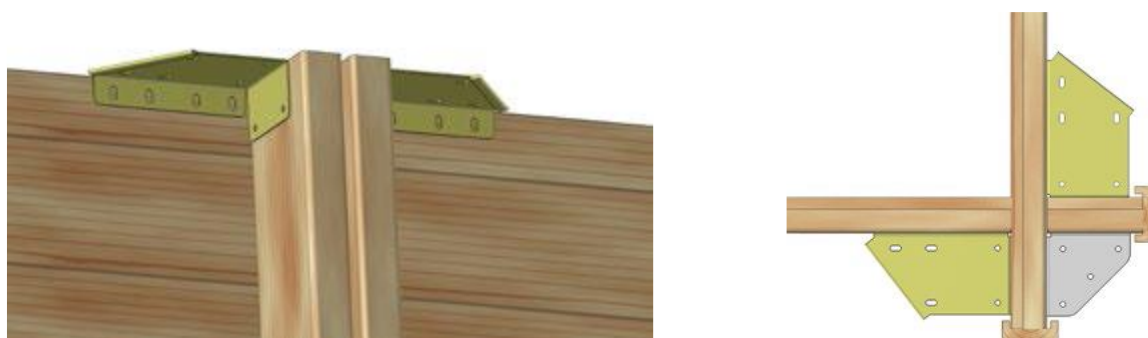
Figure 13 – Mise en place des équerres de margelles en haut des jambes de force et dans les angles
