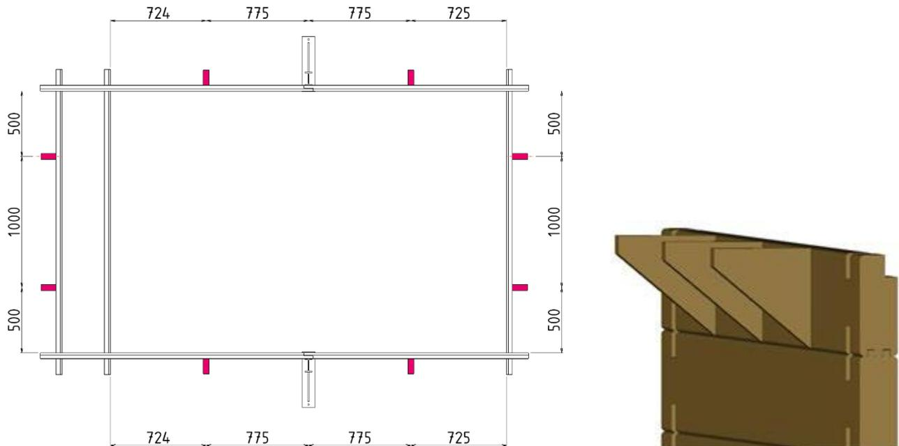
Abbildung 12 – Positionen der Holzkeile der Handläufe
