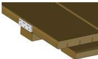
Abbildung 27 – Anbringen der Scharniere an der Holzrosten
