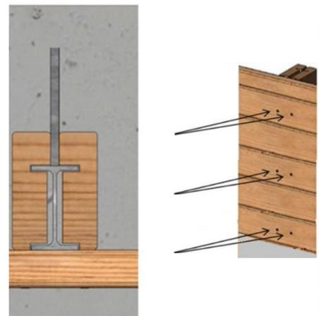
Abbildung 11 – Montage der Abschlussprofile der Streben
