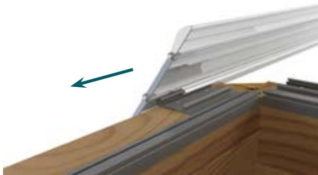
Schrauben Sie die Beschläge (402) für den Handlauf fest; führen Sie dazu eine Schraube 4,2 x 9,5 (110) in die Öffnung an jedem Beschlag, um zu verhindern, dass der Handlauf hin- und herrutschen kann. Dazu muss Folgendes gewährleistet sein:
