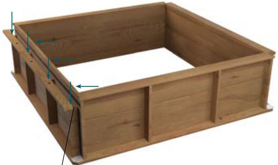
Das Festschrauben des Handlauf-Untergestells an den Enden der Leisten kann dazu führen, dass die Zungen der Leisten brechen.
