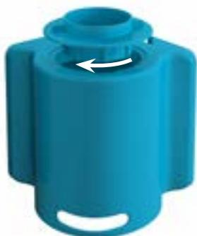
Montieren Sie die Skimmer-Tragführung (307) auf dem Filter-Oberteil (305) durch eine Viertelumdrehung.
