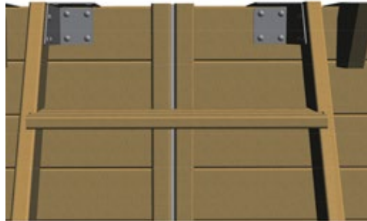
Figure 17 – fixation de l'escalier extérieur sur le bassin
