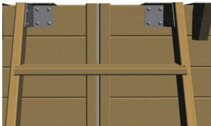
Abbildung 17 – Anbringen der Außenterrasse am Becken
