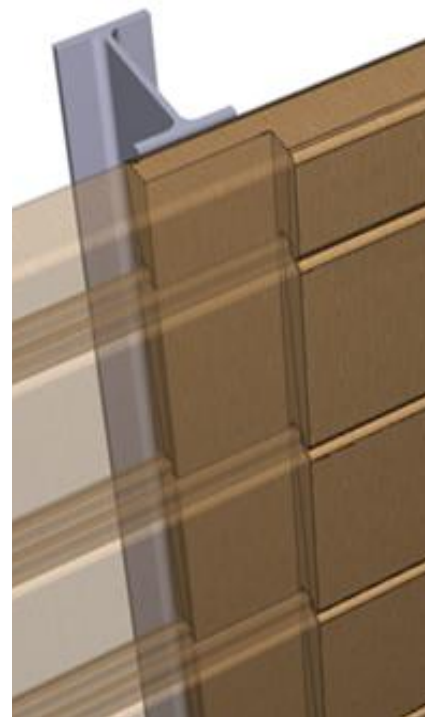
Abbildung 9b - Zusammentreffen der Bohlen an Metallstreben
