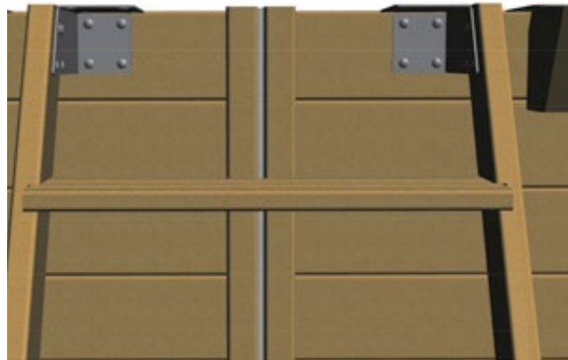
Figuur 17 – Bevestiging van de buitentrap aan het zwembad
