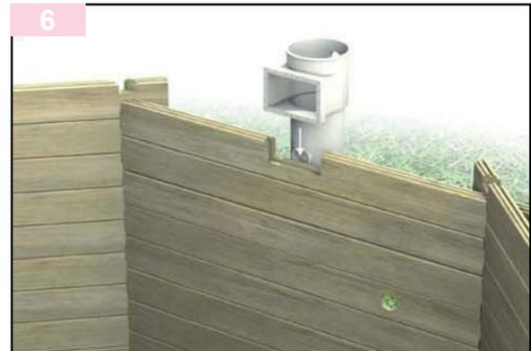
En esta fase, es necesario meter el skimmer en la pared fabricada (tipo D).
