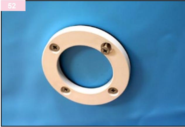
Realice el atornillado de la brida equipada con su junta adhesiva con tornillos inoxidable FZ M5x16 del kit piezas para sellar. Durante esta operación procure realizar una fijación alterna para garantizar una estanqueidad perfecta. Es preferible una fijación manual para evitar una fijación demasiado brusca que podría partir la brida.
