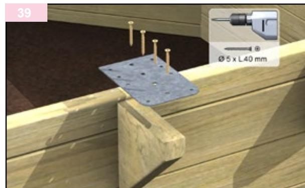
Fije en cada repisa una placa (kit repisa) destinada a la colocación del bordillo. Procure que cada placa esté bien colocada a nivel de la parte superior de las paredes. Realice un fresado en las perforaciones de las placas antes de atornillar.
