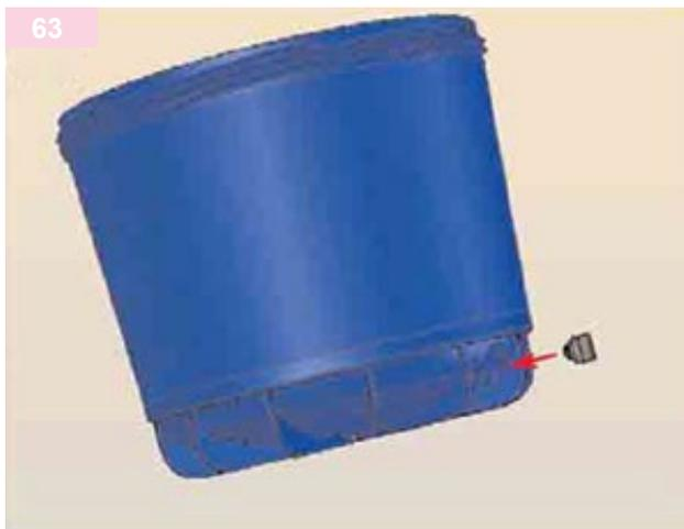
Compruebe la presencia del tapón de vaciado y de su junta.
