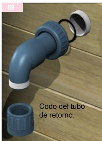
Después de haber colocado entre 4 y 5 vueltas de teflón, que encontrará en el kit de accesorios, sobre los codos de los bajantes rígidos C, rosquelos a las salidas exteriores de los tubos de retorno, sin olvidar colocar las juntas planas en el revestimiento para sellar.
