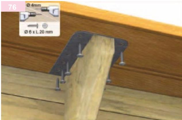
Fije las tablas con tornillos pernos (bolsa G o H) a las placas metálicas de las repisas efectuando el atornillado por debajo como se indica. Realice una ligera perforación previa para facilitar la instalación. Compruebe sobre la marcha el alineamiento correcto del conjunto.
