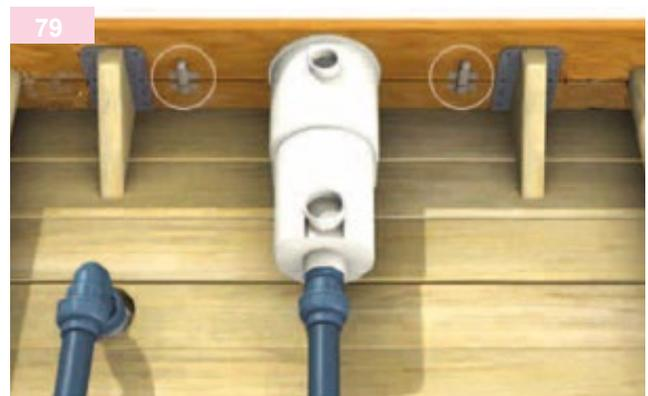
Colocación de los pestillos de bloqueo (bolsa N).
