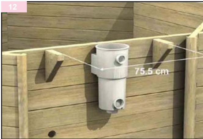
En la pared que contiene el skimmer, se colocan 2 repisas a 75,5 cm una de la otra, a ambos lados del eje del skimmer.
