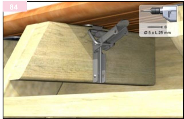
La escalera de madera cuenta con dos cierres de palanca que permiten un bloqueo eficaz de esta. Las partes de palanca se deben fijar sobre los soportes de escalera y los ganchos bajo el bordillo (encontrará estas piezas en la bolsa K). Es necesario estudiar el funcionamiento de estas 2 piezas juntas para comprender el funcionamiento y evaluar el recorrido necesario para un bloqueo eficaz de la escalera una vez en su lugar.
