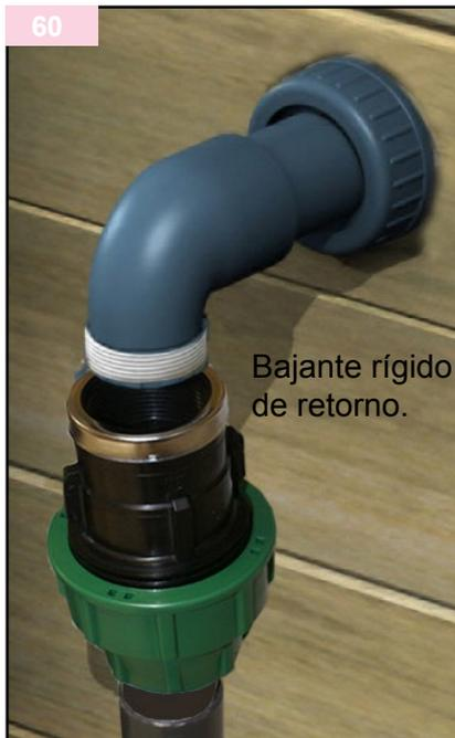
Corte el tubo del bajante rígido de la toma del limpiafondos (como se indica anteriormente y según la altura de su piscina) y después realice la instalación.
