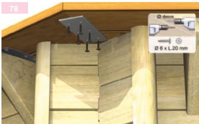
Le queda fijar debajo de cada esquina del bordillo las 8 placas metálicas con tornillos pernos (bolsa G).
