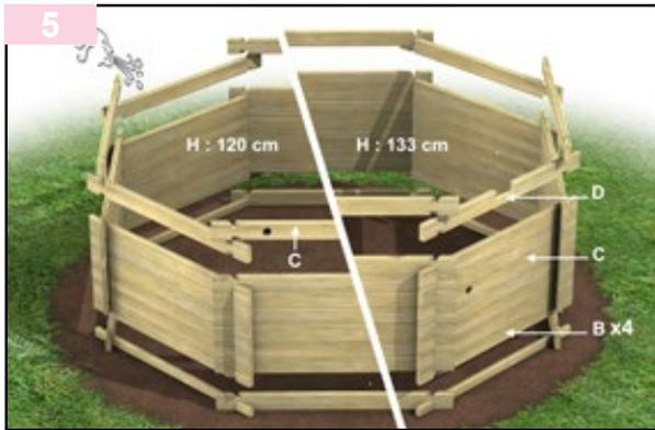
Encaje todas las paredes restantes (tipo B) prestando atención a la colocación de la pared de retorno (tipo C) y de la pared fabricada (tipo D). La pared de retorno (tipo C) debe colocarse por encima de 4 paredes (tipo B) + 1 pared (tipo A). La segunda pared perforada (C) está destinada a la toma limpiafondos. Observe su posición en la representación gráfica al final del manual. La pared de tipo D se encuentra en el mismo lado en la última fila de este paso de montaje.
