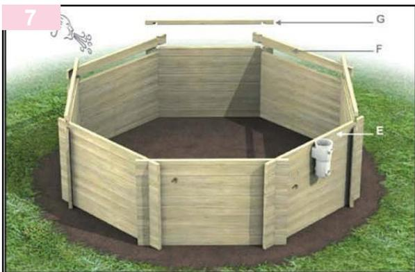
Encaje la pared fabricada adicional para skimmer (tipo E) en la parte superior de la pared de tipo D y continúe el contorno de la piscina encajando 3 paredes (tipo F) y 4 medias paredes (tipo G) como se indica.
