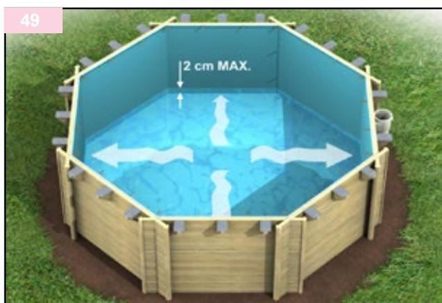
Cuando el liner esté perfectamente enganchado y en su lugar, llene la piscina con solo 2 centímetros de agua. Vuelva a llevar el máximo posible de pliegues del liner del centro hacia las paredes.
