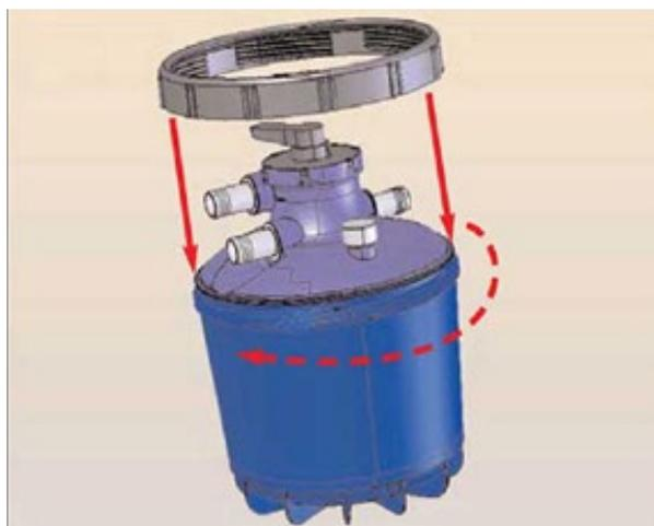
Verificare l'assenza di residui di sabbia sul bordo del serbatoio.
