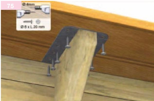
Fissare le tavole con viti a serraggio (sacchetto G o H) sulle piastre metalliche dei supporti effettuando l'avvitamento da sotto come indicato. Eseguire una leggera pre-foratura per facilitare il posizionamento. Controllate il corretto allineamento dell'insieme.
