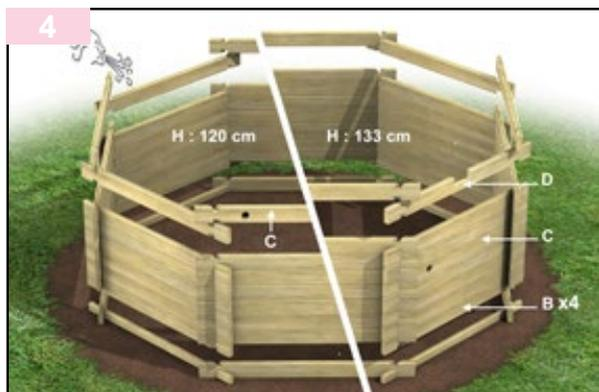
Inserire tutte le restanti assi (tipo B) curando il posizionamento della asse (tipo C) e della parte fresata (tipo D). La parete di mandata (tipo C) deve essere posizionata sopra 4 (tipo B) + 1 listello (tipo A). La seconda parete forata di tipo C ospiterà la presa per la testata aspirante. Osservare la sua posizione sul disegno esploso alla fine del foglio illustrativo. L'asse di tipo D si trova sullo stesso lato nell'ultima fila di questa fase di montaggio.
