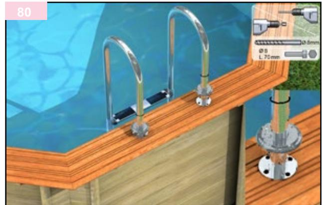
Stabilita questa scelta, regolare il posizionamento della scala prestando particolare attenzione al suo appiombamento e facendo in modo che i tamponi siano ben appoggiati sulla parete interna. Individuare le posizioni di foratura. Rimuovere la scala e quindi eseguire i fori per i bulloni di fissaggio presenti nel pacchetto della scala.
