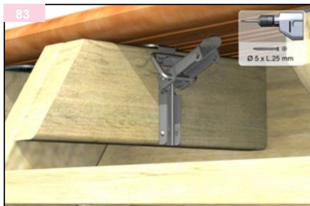
La scala in legno è dotata di due chiusure a leva che consentono un efficace bloccaggio della stessa. Le parti della leva devono essere fissate ai supporti della scala e ai ganci sotto il bordo (questi pezzi si trovano nel sacchetto K). È necessario studiare il funzionamento di questi 2 pezzi insieme per comprenderne il funzionamento e valutare la corsa necessaria per un efficace bloccaggio della scala una volta in posizione.
