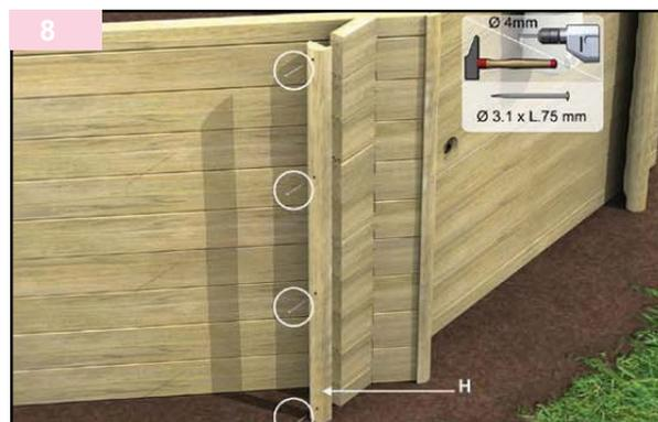
Prima di posare i profili di finitura, è necessario posare in ogni angolo un rinforzo.
