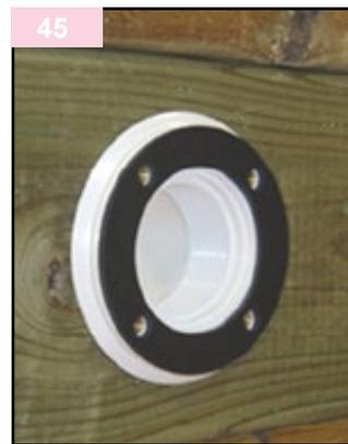
Posizionare, lato vasca, il corpo ugello (Confezione pezzi da fissare) comune alla mandata nel foro del listello fresato. Fissare con le viti VB FZ 3x25. Applicare una prima guarnizione autoadesiva su ogni condotta da parete. Effettuare il serraggio badando bene a non spaccare il corpo dell'ugello. Preferire un accurato serraggio manuale.
