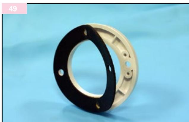
Posizionare la guarnizione adesiva sulla flangia del corpo dell'ugello di mandata.
