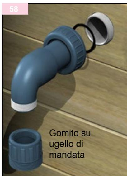
Dopo aver applicato 4-5 giri di teflon, disponibile nel sacchetto accessori, sui gomiti delle discese rigide C, avvitarle sulle uscite esterne degli ugelli di mandata senza dimenticare di mettere in posizione le guarnizioni piatte fornite nel sacchetto da fissare.
