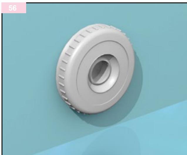
Avvitare il gruppo snodo orientabile sul corpo della mandata. L'ugello dovrà essere orientata verso sinistra per favorire un movimento d'acqua necessario al buon funzionamento del sistema filtrante.
