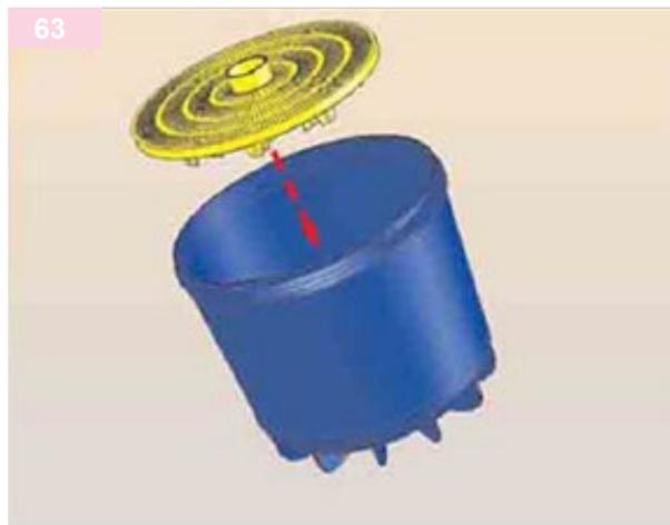
Posizionare il la base forata sul fondo del serbatoio.
