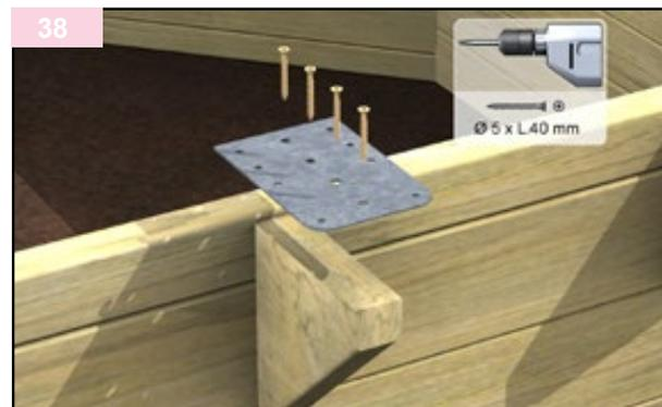
Fissare su ciascun supporto una placca metallica (kit mensola) destinata al fissaggio del bordo. Assicurarsi che ogni placca sia ben posizionata e che affiori dalla parte superiore delle pareti. Eseguire una fresatura sulle forature delle piastre prima dell'avvitamento.
