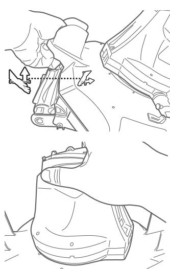
**ATT TÄNKA PÅ NÄR DU SKA PLOCKA UPP ROBOTEN:** För modellerna med vals, plocka upp roboten från vattenytan genom att ta tag i fenant och svivelhuvudet. Se till att alltid ta tag i fenant på den sida där handsymbolen finns (se bilden) för att undvika att skrap ramlar ned i poolen när du plockar ut roboten ur vattnet.
