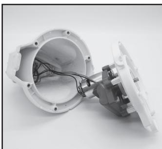
3. Ta ut batteripaketet för att exponera kretskortet. För att lossa batteriets anslutningstråd trycker du ned kontaktenens klämma och drar ut den. **ANMÄRKNING:** Linda omedelbart kontakten med isoleringstejp för att undvika kortslutning orsakad av att de två trådanslutningarna kommer i kontakt med varandra.
