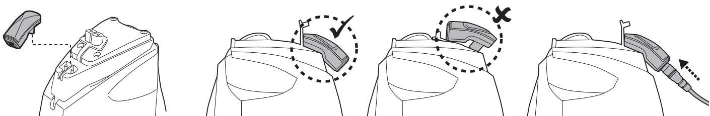
3. Conecte el adaptador externo a la fuente de alimentación. El indicador LED del adaptador externo se vuelve rojo después de que comienza la carga. El indicador LED del adaptador externo se vuelve verde cuando el robot esta cargado.
