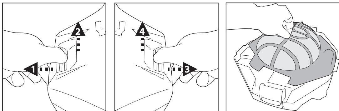
2. Irrota suodatinsuojuks ja poista roskat säiliöstä. On suositeltavaa puhdistaa suodatinsuojuks roiskuttamalla siihen vettä. Jos harjaus katsotaan tarpeelliseksi, käytä vain pehmeää harjaan huolellisesti ja varovasti vaurioiden välttämiseksi.
