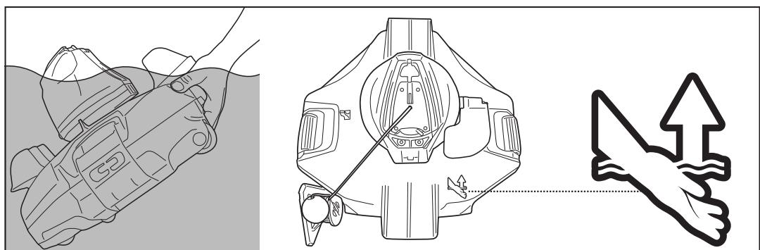
5. Schieben Sie den Schalter auf **AUS**. Spülen Sie den Poolroboter nach jedem Einsatz mit sauberem Wasser ab. Verwenden Sie dazu **KEINE** Reinigungsmittel.
