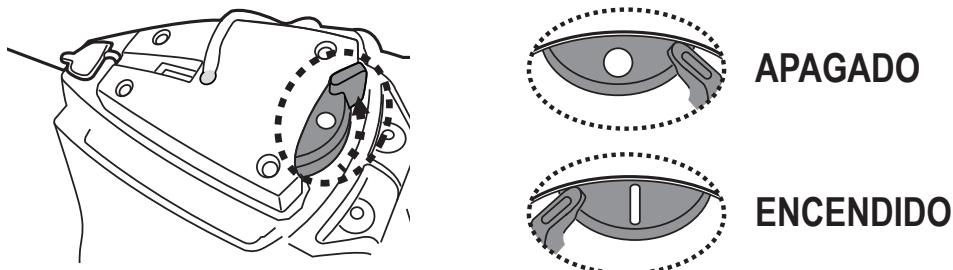
2. Levante la protección. Alinee y asegure el enchufe de carga al puerto de carga.
