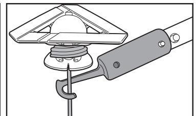
När roboten når vattenytan greppar du handtaget under basen som är märkt med en handsymbol ( se bilden nedan ) för att underlätta upptagning ur poolen. Se till att alltid greppa roboten i denna ände för att undvika att skräp faller ut i poolen när du plockar upp roboten.
