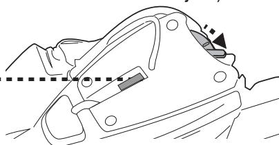
3. Liu'uta virtakytkin asentoon "PÄÄLLÄ" ( robotin ollessa vielä veden alla ) - merkkivalo sytyy ja moottori aktivoituu automaattisesti ( vedenpinnan peittävä käentyvän yläkappaleen yläosassa olevat anturit ). Anna robotin vajota altaan pohjaan ja tarkkaile sen ensimmäisiä eteenpäin ja taaksepäin - liikkeitä altaan pohjalla. Jos se kulkee altaan seinää seuraten eikä kohtisuoraan, nosta se ylös ja laita takaisin varmistaen, että sen etu - / takaosa on altaan seinää vasten.
