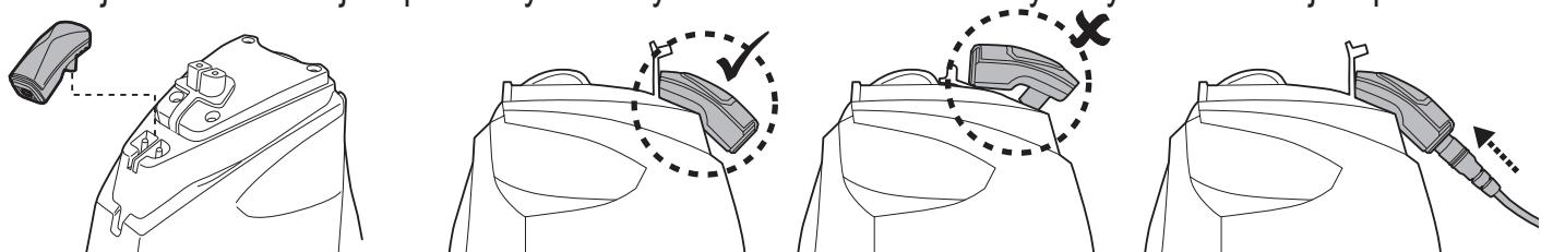
3. Připojte externí adaptér ke zdroji napájení. Jakmile se začne robot nabíjet, rozsvítí se kontrolka na externím kabelu zeleně.
