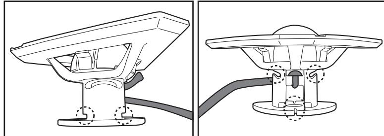
De juiste lengte van het koord moet gelijk zijn aan de afstand tussen de bovenkant van de robot en het waterniveau.
