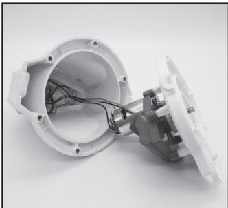
3. Sortir la batterie pour exposer la PCBA. Pour détacher le fil de connexion de la batterie, appuyer sur le clip du connecteur, puis le retirer. **REMARQUE:** Envelopper le connecteur immédiatement avec du ruban isolant afin d'éviter les court-circuits causés par le contact des deux bornes.
