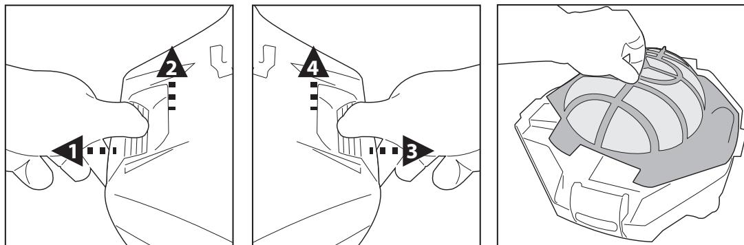
2. Снимите крышку фильтра и удалите мусор из отсека. Рекомендуется промывать сетку крышки фильтра струей воды. Если воды недостаточно для удаления остатков мусора с сетки крышки фильтра, осторожно используйте только мягкую щетку, чтобы не повредить сетку.
