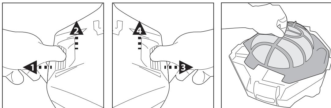
2. Retire a tampa do filtro e remova os resíduos do compartimento. Recomenda-se que limpe a rede da tampa do filtro com Água. Se a escovagem for tida como necessária, utilize apenas uma escova suave para limpar de forma cuidadosa e adequada para evitar danos.
