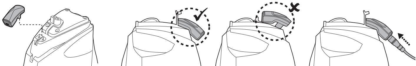
3. Anslut den externa adapttern till strömkällan. Indikatorlampen på den externa adapttern lyser rött när laddningen påbörjats. Indikatorlampen på den externa adapttern kommer att lysa grönt när roboten är fulladdad.
