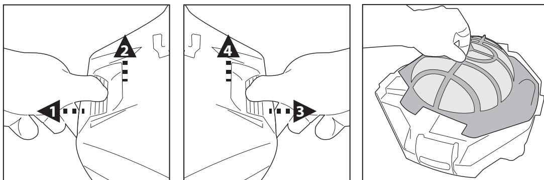
2. Rimuovere il coperchio e la piastra del filtro e rimuovere i detriti dal compartimento. Si raccomanda di pulire il coperchio del filtro e della piastra del filtro di drenaggio con acqua corrente. Se è necessario spazzolare, utilizzare esclusivamente una spazzola morbida per pulirlo delicatamente evitando di danneggiarlo.
