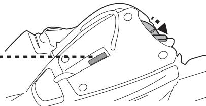
3. Skjut strömbrytaren till läget "PÅ" ( medan roboten fortfarande är under vattenytan ) – indikatorlampa tänds och motorn aktiveras automatiskt ( om sensorerna på svivelhuvudet är under vattenytan ). Låt roboten sjunka till poolens botten och kontrollera att den börjar köra fram och tillbaka över poolens botten. Om roboten kör längs med poolens vägg i stället för vinkelrätt mot den halar du in den och flyttar på den så att dess fram-/bakdel är riktad mot poolens vägg.
