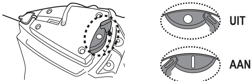
2. Wrik de beschermkap open. Lijn de laadstekker uit en bevestig deze aan de laadpoort.
