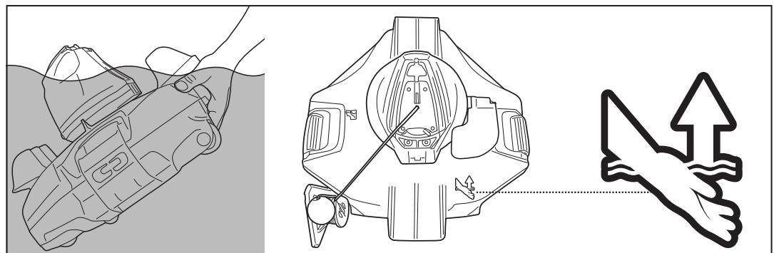
5. Deslique o interruptor para OFF. Lave o robô com água fresca a cada utilização. NÃO utilize qualquer detergente.
