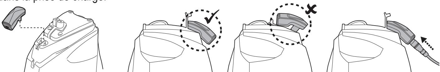
3. Connecter le transformateur à la source d'alimentation. Le voyant de l'adaptateur externe devient rouge une fois que la charge commence. Le voyant de l'adaptateur externe devient vert lorsque le robot est chargé.
