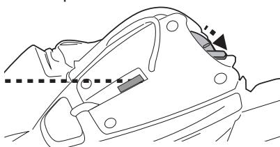
3. Posuňte vypínač do polohy „ON“ ( když je robot stále ponořen ) - rozsvítí se kontrolka a automaticky se aktivuje motor ( hladina vody zakrývající senzory v horní části otočné hlavy ). Nechte robota klesnout na dno bazénu a sledujte jeho první pohyby dopředu a dozadu na dně bazénu. Pokud se pohybuje podél stěny bazénu a ne kolmo, vytáhněte jej a znova ponorte, přičemž se ujistěte, že jeho přední/zadní strana směruje ke stěně bazénu.
