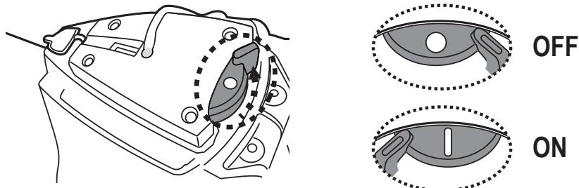
2. Fare leva sul cappuccio protettivo. Allineare e collegare la spina di ricarica alla porta di ricarica.
