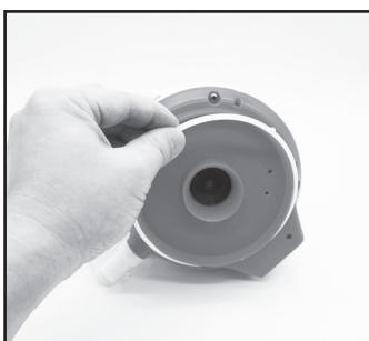
2. Använd skruvmejseln för att lossa de 4 skruvarna på undersidan av huvudet för att ta av den undre plattan först. Lossa sedan alla skruvarna vid basen enligt bildanvisningarna. Plocka bort fläktjulet och band upp basen för att frilägga huvudet inuti.
