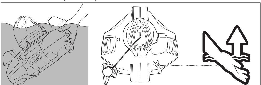
5. Schuif de schakelaar in de UIT-positie. Spoel de robot na elk gebruik met schoon water. Gebruik GEEN schoonmaakmiddelen.
