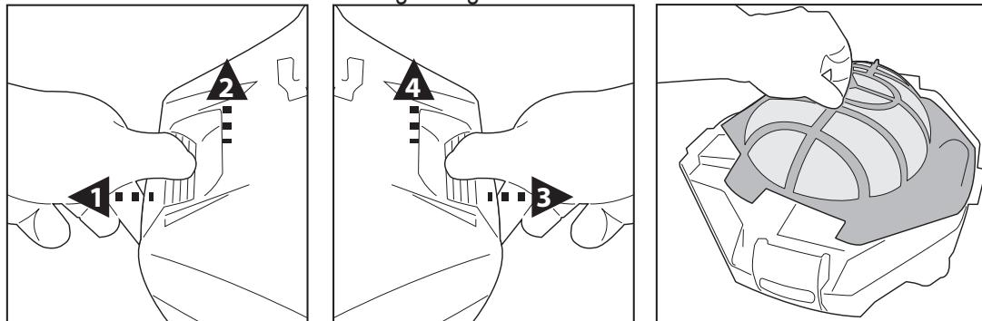
2. Bauen Sie die Filterabdeckung heraus und entfernen Sie den Schmutz aus dem Behälter. Es wird empfohlen, das Filterabdecksieb mit laufendem Wasser zu reinigen. Sollte das Sieb gebürstet werden müssen, verwenden Sie ausschließlich eine weiche Bürste und reinigen Sie es vorsichtig und sanft, um es nicht zu beschädigen.
