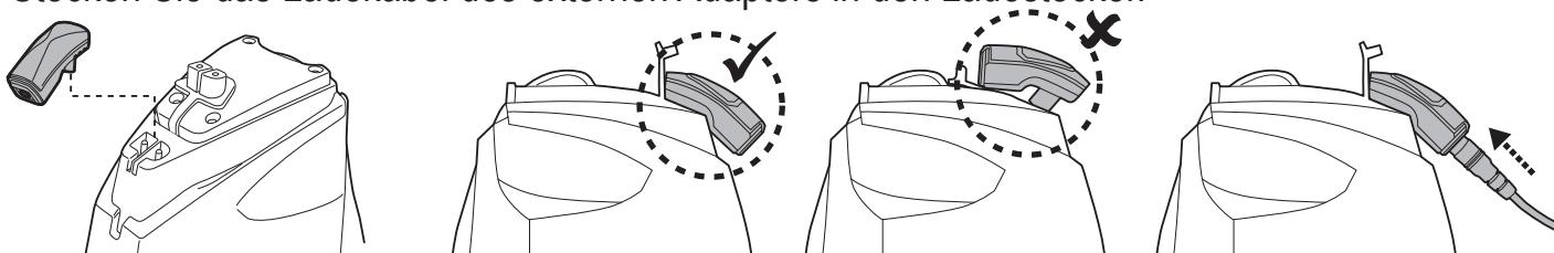
3. Verbinden Sie den externen Adapter mit der Stromquelle. Die Anzeigeleuchte am externen Adapter leuchtet rot, sobald der Ladevorgang beginnt. Die Anzeigeleuchte am externen Adapter leuchtet grün, wenn der Roboter aufgeladen ist.
