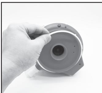
2. Use el destornillador para desatornillar los 4 pernos situados en la parte inferior del cabezal para liberar la placa inferior. Desatornille todos los pernos de la base, tal como aparece en la imagen. Retire el propulsor, tire de la base y sáquela para dejar el cabezal al descubierto.
