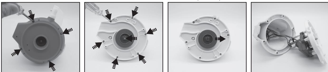
3. Estrarre la batteria per esporre il PCBA. Per estrarre il cavo di connessione della batteria, premere il gancio sul connettore ed estrarlo. **NOTA:** Avvolgere immediatamente il connettore con nastro isolante per evitare corto circuiti provocati dal contatto di entrambi i terminali dei cavi.
