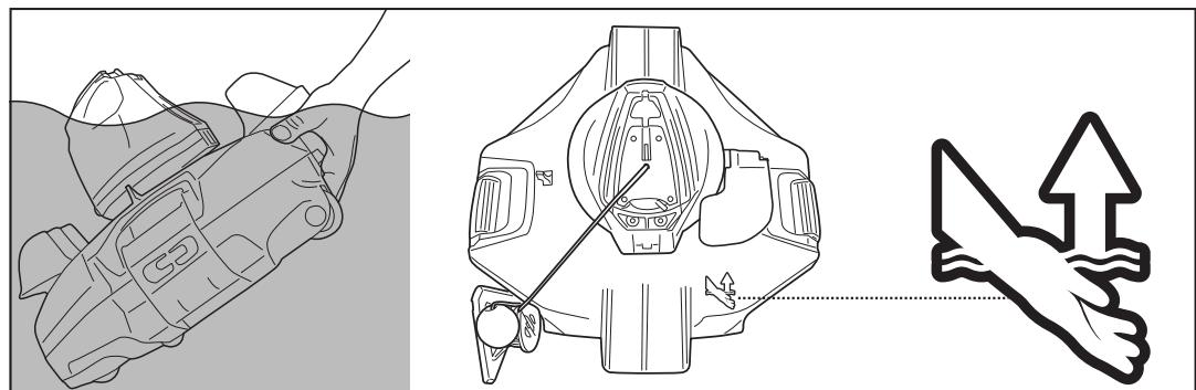
5. Scorrere l'interruttore sulla posizione OFF. Risciacquare il robot con acqua fresca dopo ogni uso. NON usare detergenti.
