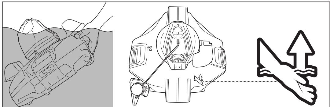
5. Skjut strömbrytaren till läget AV. Skölj roboten med rent vatten efter varje användning. Använd INTE rengöringsmedel.
