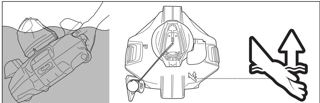
5. Coloque el interruptor en posición APAGADO. Enjuague el limpiafondos con agua limpia tras cada uso. NO use detergentes.
