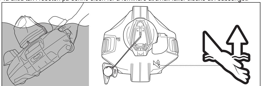
5. Skyv strømbryteren til AV. Skyll roboten med rent vann etter hver bruk. IKKE bruk rengjøringsmiddel.
