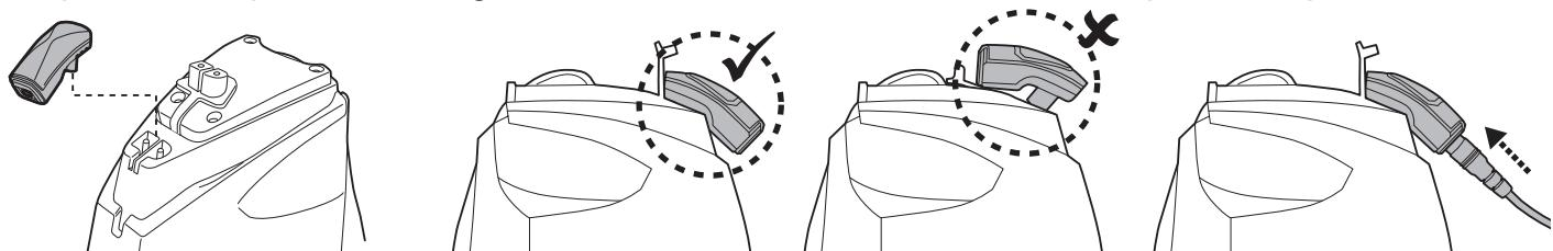
3. Steek de externe adapter in een stopcontact. Het indicatielampje op de externe adapter wordt rood als het laden begint. Het indicatielampje op de externe adapter wordt groen wanneer de robot is opgeladen.
