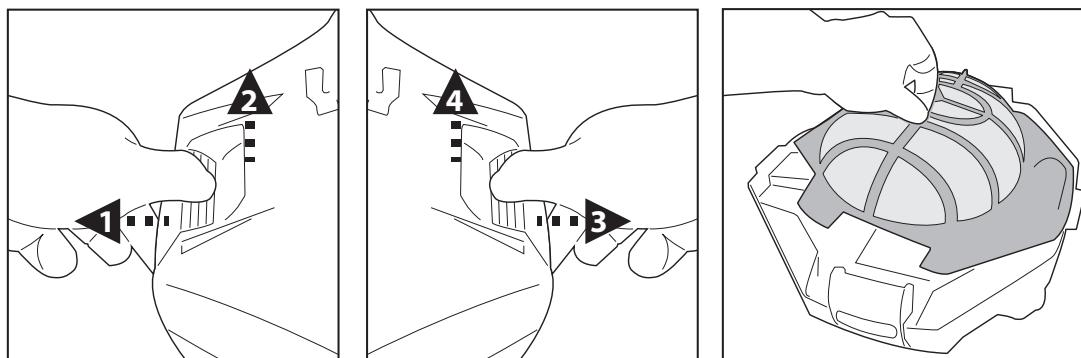
2. Retire el filtro y vacíe la suciedad del compartimento. Se recomienda limpiar la malla del filtro con agua. Si requieren cepillado, utilice un cepillo suave y límpielas con delicadeza para evitar deteriorarlas.
