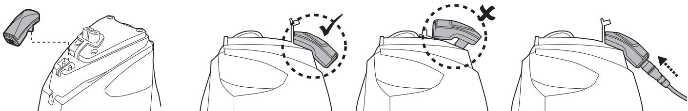
3. Collegare l'adattatore esterno alla fonte di alimentazione. L'indicatore luminoso sull'adattatore esterno diventa rosso una volta iniziata la ricarica. L'indicatore luminoso sull'adattatore esterno diventerà verde quando il robot è carico.
