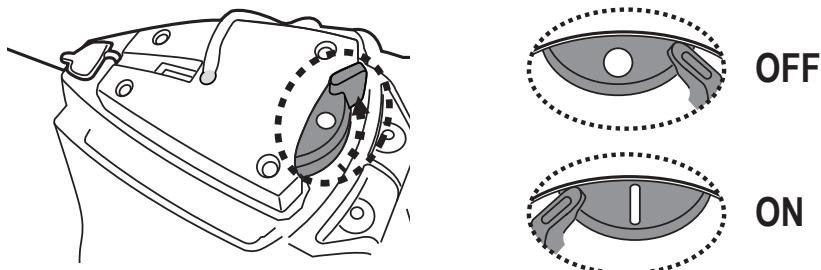
2. Abra a tampa de proteção. Alinhe a anexe a tomada de carregamento com a porta de carregamento.
