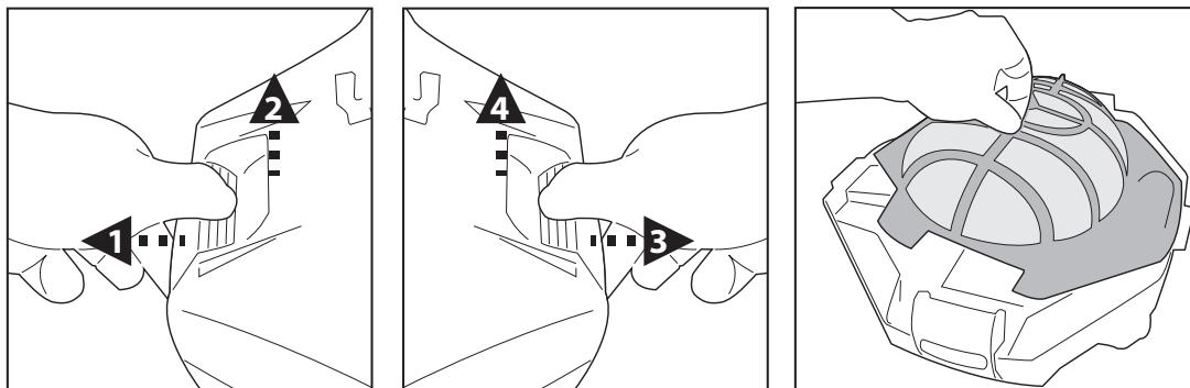
2. Lossa filterkåpan och töm behållaren på skräp. Vi rekommenderar att du rengör filterkåpans nät med rinnande vatten. Vid behov kan du även rengöra nätet försiktigt med en mjuk borste för att undvika att skada det.
