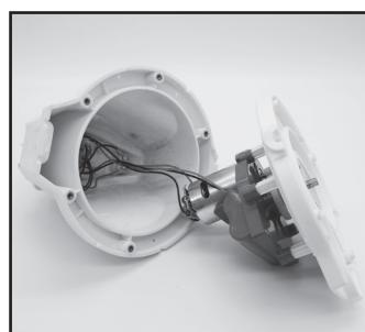
3. Fjern batteripakken for å vise kretskortet. For å koble fra batteriledningen må du trykke på klipsen på koblingen for å dra den ut. **MERK:** Pakk koblingen inn i isolasjonsteip øyeblikkelig, for å unngå kortslutning forårsaket av kontakt med begge ledningsterminalene.
