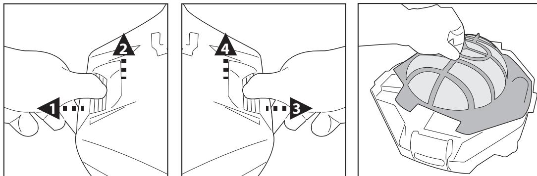
2. Retirer le filtre puis nettoyer le compartiment à débris. Il est recommandé de nettoyer le filtre à l'aide d'un jet d'eau. Si un brossage est jugé nécessaire, utiliser seulement une brosse souple pour nettoyer délicatement afin de ne pas endommager le filtre. N'appliquer aucune pression sur le filtre.
