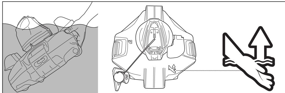
5. Liu'uta virtakytkin pois päältä -asentoon. Huuhtele robotti puhtaalla vedellä jokaisen käytön jälkeen. ÄLÄ käytä mitään pesuainetta.
