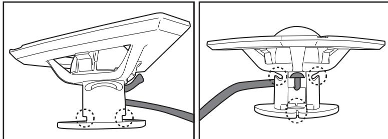
La longueur correcte du cordon doit être équivalente à la distance entre la partie supérieure du robot et le niveau de l'eau. NOTE: Une longueur excessive peut faire tordre le cordon et, en conséquence, affecter le résultat.
