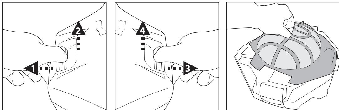
2. Vyndejte kryt filtru a odstraňte nečistoty z prostoru. Doporučujeme vyčistit síťku filtru proudem vody. Pokud považujete za nutné síťku kartáčovat, čistěte ji jemně, pouze měkkým kartáčem, a to tak, aby nedošlo k jejímu poškození.
