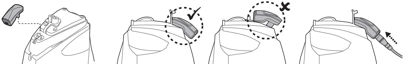
3. Conecte o adaptador externo à fonte de alimentação. A luz indicadora no adaptador externo fica vermelha assim que o carregamento começa. A luz indicadora no adaptador externo ficará verde quando o robô está carregado.
