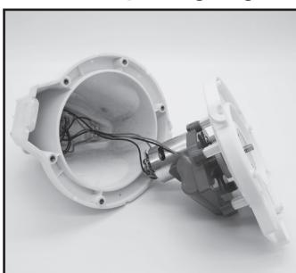
3. Akku herausnehmen, so dass PCBA zugänglich ist. Um die Anschlussdrähte vom Akku zu lösen, auf den Clip am Stecker drücken und dann herausziehen. **HINWEIS:** Umwickeln Sie den Stecker sofort mit Isolierband, um einen Kurzschluss durch einen Kontakt der beiden Drahtenden zu vermeiden.
