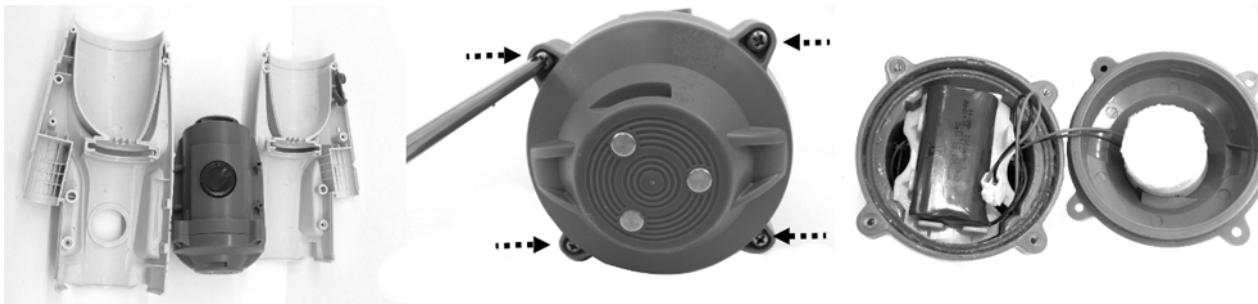
4. Verwenden Sie einen Kreuzschlitzschraubendreher, um die Schraube an der Ecke der geraden Trägerplatte zu lösen. Ziehen Sie die Platte mit einer Klemme heraus, um die Leiterplatte und ihre Kabelstecker freizulegen
