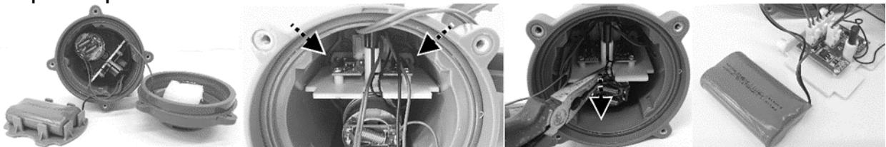
5. Individuare il connettore centrale come mostrato: premere sulla clip ed estrarre lo. NOTA: avvolgere immediatamente il connettore con nastro isolante per evitare cortocircuiti causati dal contatto di entrambi i terminali del filo.
