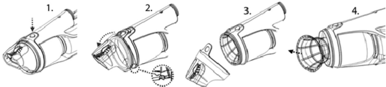
**ATTENZIONE!** Sostituire immediatamente il calza filtrante danneggiato, prima di riutilizzare il aspiratore per piscina.
