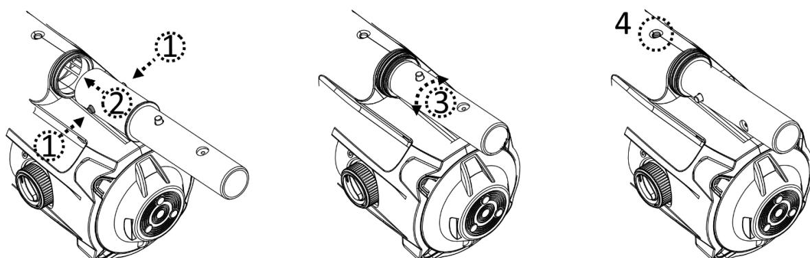
Schieben Sie die Teleskopstange auf die Teleskopstangenkupplung. Drücken Sie die seitlichen Stifte der Kupplung und der Teleskopstange weiter herunter, bis die Kupplungsstifte in den Löchern der Stange einrasten.
