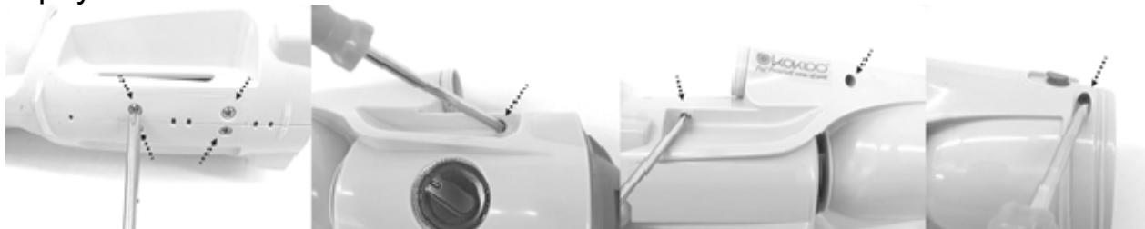
3. Разделите корпус на две половины, чтобы получить доступ к основной камере. С помощью отвертки Philips снимите торцевую крышку, чтобы получить доступ к аккумуляторной батарее.
