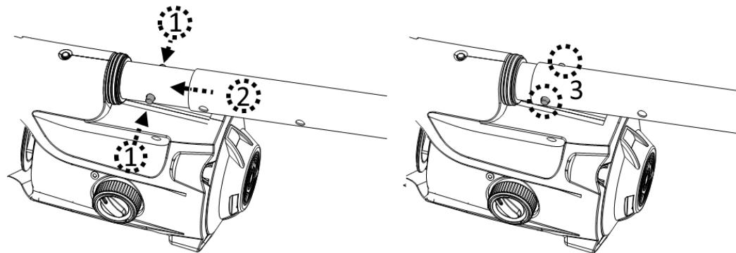
For å løsne teleskopstangen, trykk ned sidepinnene samtidig og trekk ut stangen.
