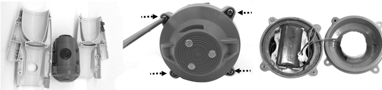
4. Använd Philips skruvmejsel för att lossa skruvarna i hörnen av stödplattan som pilarna visar på bilden. Använd en tång för att få tag i plattan och dra ut den för att frigöra trådanslutningarna på kretskortet.
