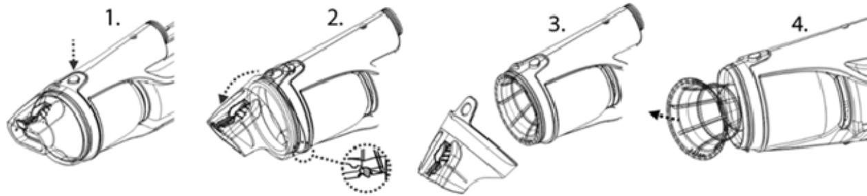
**OPGELET!** Vervang een beschadigde filterkegel onmiddellijk door een nieuwe filterkegel I, voor u de bodemzuiger weer gebruikt.
