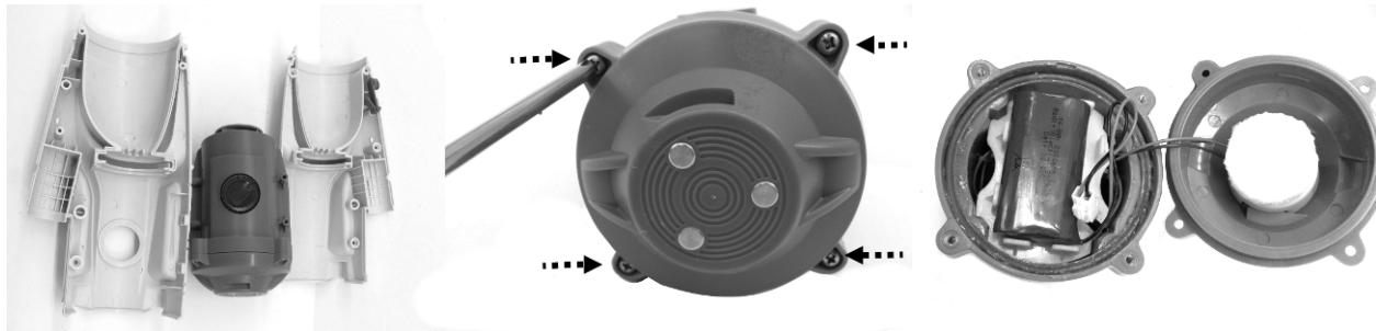
4. Bruk en Philips skrutrekker for å løsne skruene på hjørnet av støtteplaten som vist. Bruk en klemme for å ta tak i platen, og dra den ut for å avdekke ledningskoblingene på kretskortet.
