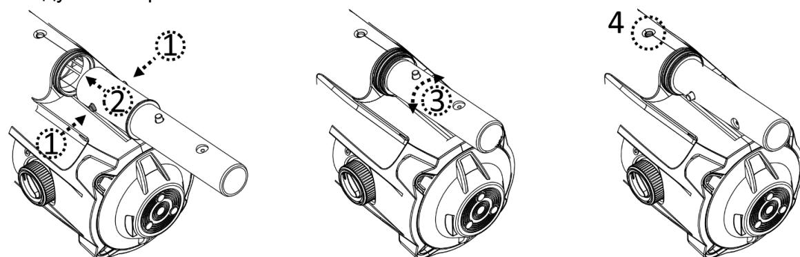
Наденьте телескопическую штангу на вставку. Нажмайте на боковые штифты вставки и сдвигайте телескопическую штангу дальше вниз, пока штифты соединительной вставки не зафиксируются внутри отверстий штанги.
