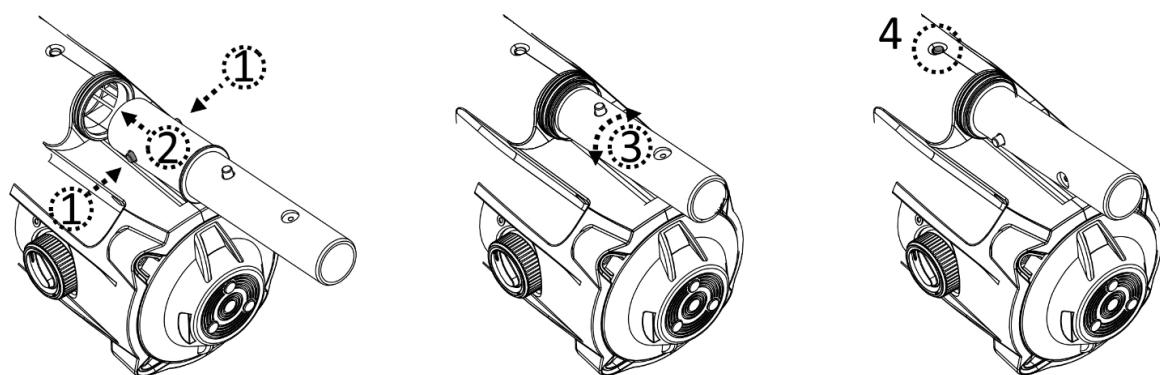
Deslize o mastro telescópico para o conector de mastro. Prima os pinos laterais do conector e deslize o mastro telescópico para baixo até que os pinos do conector fiquem seguros dentro dos orifícios do mastro.
