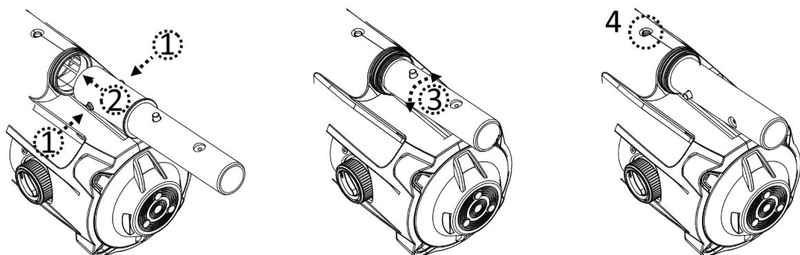
Glisser le manche télescopique autour du connecteur. Appuyer sur les broches latérales du connecteur and continuer à faire glisser le manche télescopique plus bas jusqu'à ce que les broches des connecteurs soient insérées dans les trous du manche.
