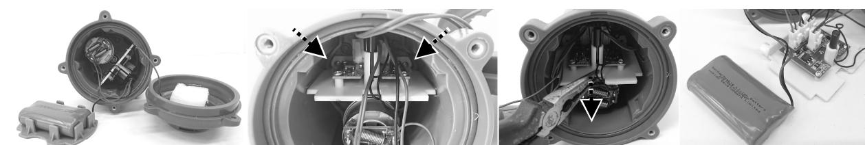
5. Найдите средний разъем, как показано, нажмите на зажим на разъеме и вытащите его. ПРИМЕЧАНИЕ: Немедленно оберните контакты изолентой, чтобы избежать короткого замыкания, вызванного контактом обеих клемм проводов.
