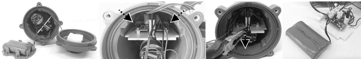
5. Situer le connecteur du milieu comme montré – appuyer sur son clip et l'extraire. NOTE: Enrouler le connecteur immédiatement avec du ruban isolant pour éviter un court-circuit causé par un contact des deux bornes de fils.
