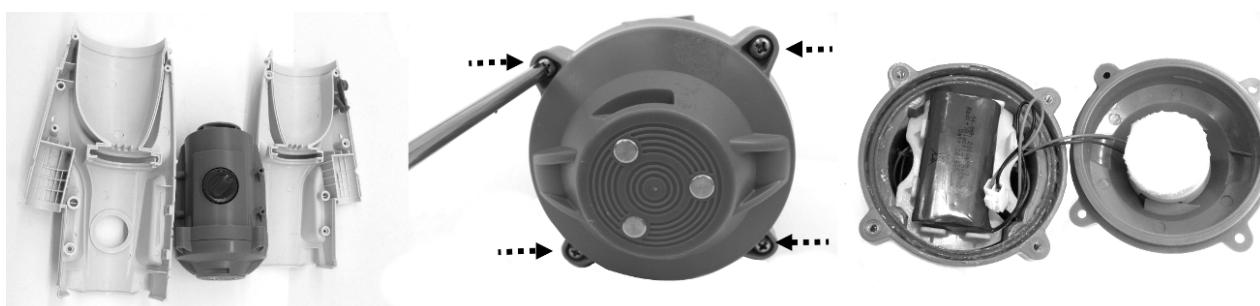
4. Pomocí šroubováku Philips odšrouubujte šroub na rohu opěrné děsky tak, jak je znázorněno níže. Pomocí svorky si přichytěte desku a vytáhněte ji, címž se dostanete ke konektorům vodičů na desce plošných spojů (PCB).
