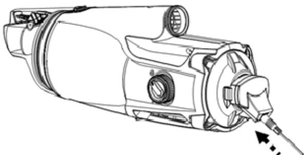
4. Conecte el adaptador externo a la fuente de alimentación. Cuando la aspiradora de piscina empiece a cargarse, el piloto indicador del adaptador externo se pondrá rojo. Normalmente se tardan unas 4-6 horas en conseguir una carga completa. El piloto indicador se pondrá verde cuando la aspiradora de piscina esté casi cargada al máximo.
