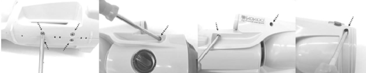
3. Separera kroppen i två halvor för att komma åt huvudenheten. Använd en Philips skruvmejsel för att plocka bort ändkåpan och komma åt batteripaketet.
