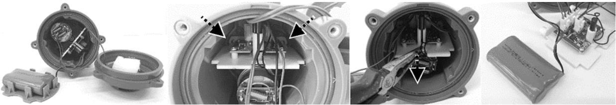
5. Zoek de middelste connector zoals op de afbeelding - druk op de clip en trek hem eruit. OPMERKING: Wikkel de connector onmiddellijk in met isolatietape om kortsluiting door het contact van beide draadklemmen te voorkomen.
