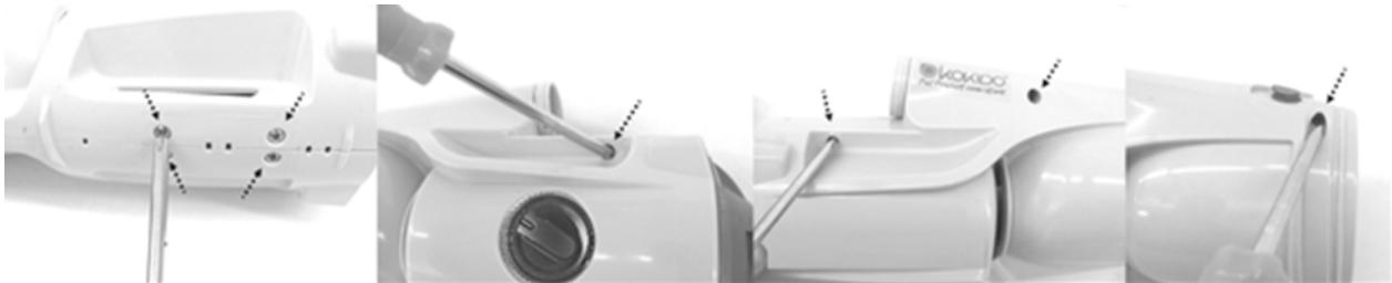
3. Séparer le corps en deux moitiés pour accéder à l'unité principale. Utiliser un tournevis Philips pour desserrer toutes les vis sur le capot d'extrémité et retirer le capot d'extrémité pour accéder au bloc-batterie.
