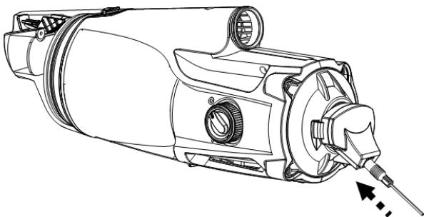
4. Ligue o adaptador externo à fonte de alimentação. Assim que o aspirador de piscinas começar a carregar, a luz indicadora no adaptador externo ficará vermelha. Normalmente, demora cerca de 4-6 horas a alcançar a carga total. A luz indicadora ficará verde assim que o aspirador de piscinas estiver totalmente carregado.
