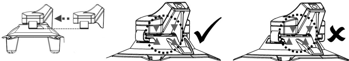
3. Brancher la prise de l'adaptateur externe dans l'orifice de chargement à la fin de la base de chargement.
