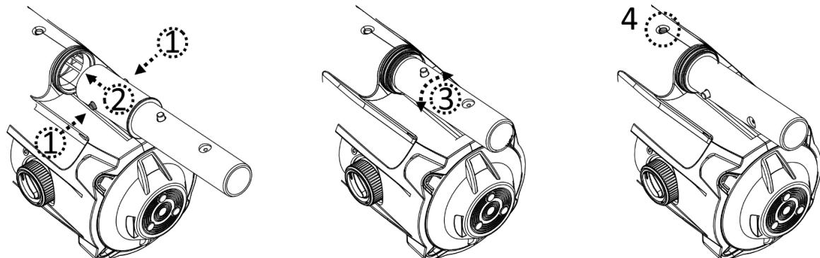
Skyv teleskopstangen på stangkoblingen. Trykk på koblingens sidepinner, og skyv teleskopstangen lengre ned til koblingens pinner er sikret i hullene i stangen.
