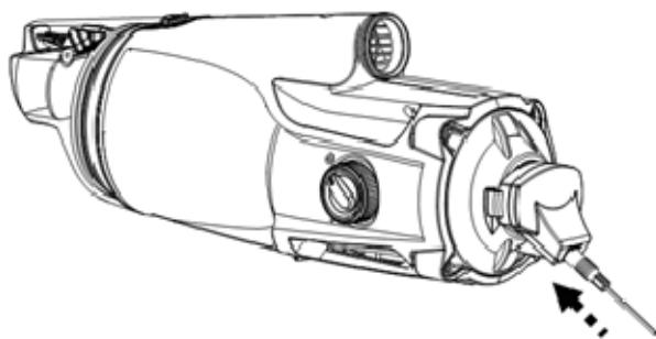
4. Verbinden Sie das externe Ladegerät mit der Stromversorgung. Nachdem der Poolsauger mit der Aufladung begonnen hat, leuchtet die Leuchtanzeige am externen Ladegerät rot. Normalerweise dauert ein vollständiger Ladevorgang 4-6 Stunden. Die Leuchtanzeige leuchtet grün, sobald der Poolsauger fast vollständig aufgeladen ist.
