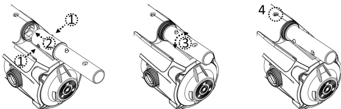
Far scorrere il manico telescopico nel connettore del palo. Premere i perni laterali del connettore e far scorrere il palo telescopico all'interno finché i perni del connettore sono fissati all'interno dei fori del palo telescopico.
