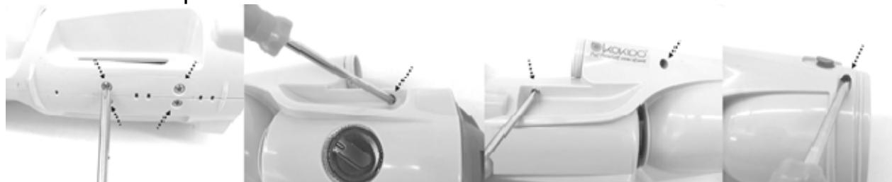
3. Separer hoveddelen i to halvdeler for å få tilgang til hovedkammeret. Bruk en Philips skrutrekker til å fjerne endedekselet, og få tilgang til batteripakken
