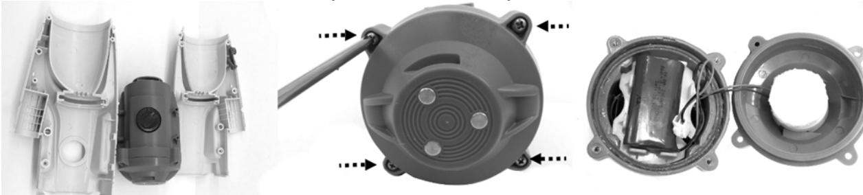
4. Utiliser un tournevis pour desserrer la vis sur le coin de la plaque de support rectiligne. Utiliser une fixation pour retirer la plaque afin de laisser à découvert le PCB et ses serre-fils.
