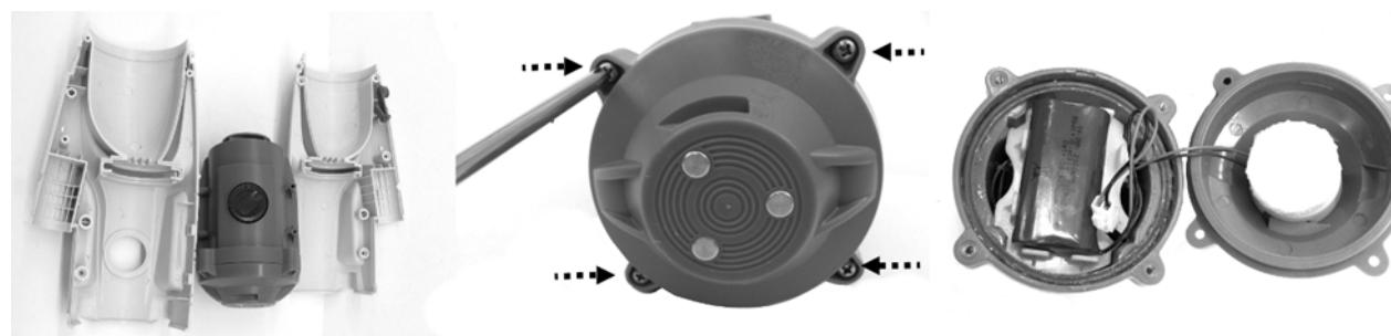
4. Gebruik een Philips-schroevendraaier om de schroef op de hoek van de rechte steunplaat los te maken. Gebruik een klem om de plaat uit te trekken om de printplaat en de draadaansluitingen bloot te leggen.
