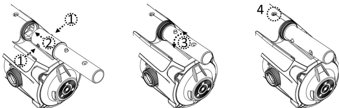
Schuif de telescopische arm op het koppelstuk. Druk op de zijpinnen van het koppelstuk en schuif de telescopische paal verder totdat de pinnen van het koppelstuk vastzitten in de gaten van de telescopische paal.
