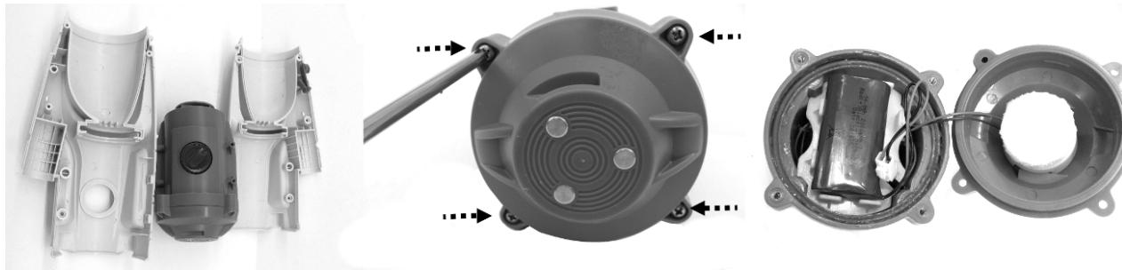
4. Utilize uma chave de fendas Philips para desaparafusar o parafuso no canto da placa de apoio conforme indicado. Utilize uma abraçadeira para segurar a placa e a puxar para fora para expor os conectores de cabo no PCB.
