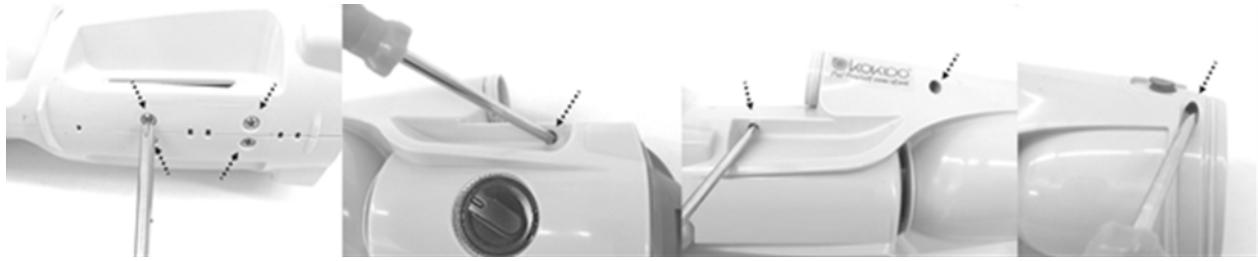
3. Trennen Sie die Gehäusehälften, um die Haupteinheit freizulegen. Lösen Sie mit einem Kreuzschlitzschraubendreher alle Schrauben an der Endabdeckung und entfernen Sie die Endabdeckung, um Zugang zum Batteriepack zu erhalten.
