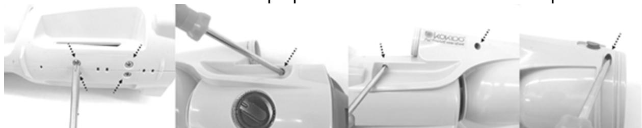
3. Separare il corpo in due metà per accedere all'unità principale. Utilizzare un cacciavite Philips per allentare tutte le viti sulla copertura terminale e rimuovere la copertura terminale per accedere alla batteria.
