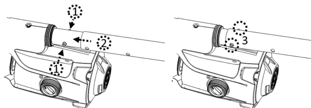
Druk tegelijkertijd op beide zijpinnen om de telescopische arm opnieuw los te maken. Trek vervolgens de telescopische arm achteruit om deze te verwijderen uit het koppelstuk.
