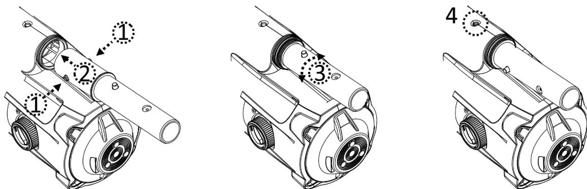
Inserte el conector dentro la pértega telescópica. Pulse los pasadores laterales del conector y deslice la pértega telescópica hasta que los pasadores laterales queden fijados en los orificios de la pértega.
