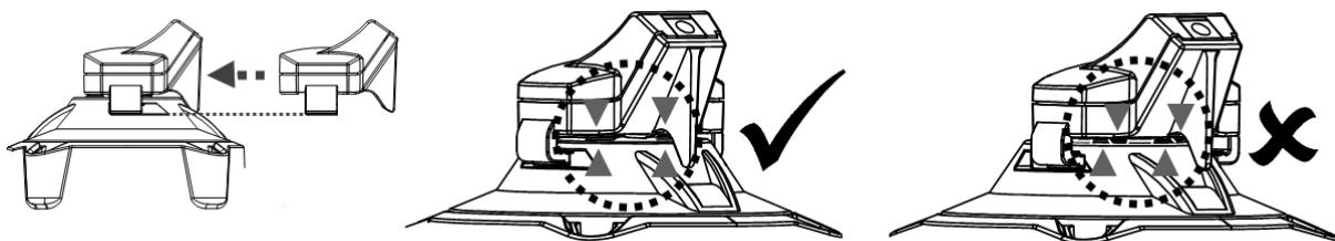
3. Stecken Sie die Buchse des externen Adapters in den Ladeanschluss am Ende des Ladestation.
