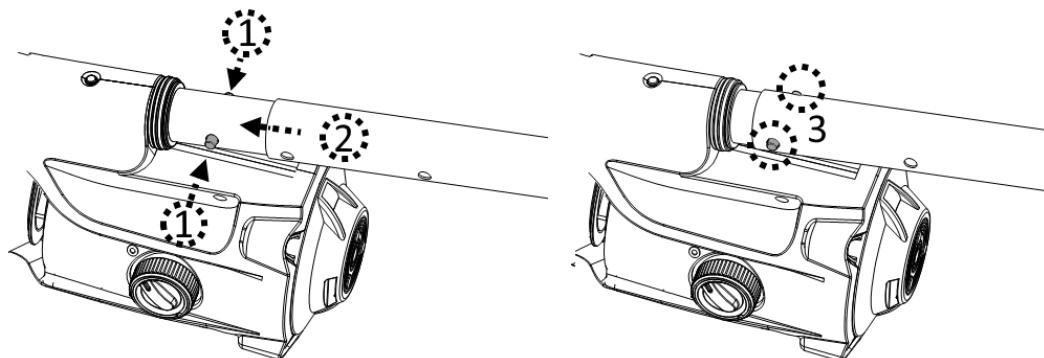
Um Teleskopstange zu lösen, drücken Sie die beiden seitlichen Stifte gleichzeitig nach unten und ziehen Sie die Stange heraus.
