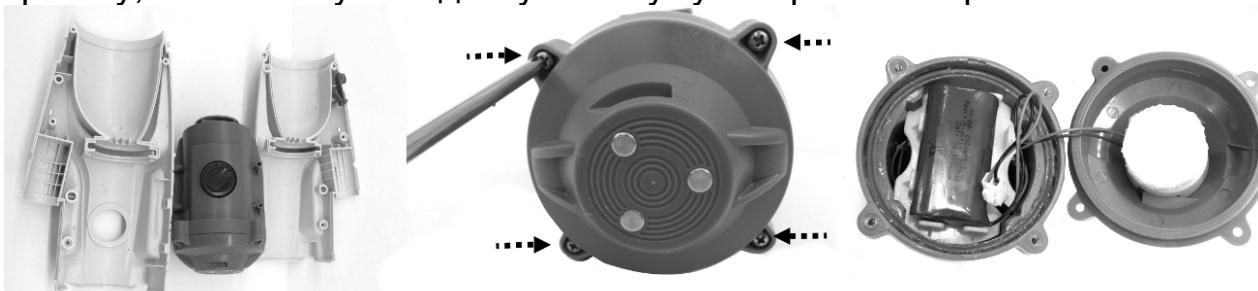
4. С помощью крестовой отвертки открутите винт в углу опорной пластины, как показано на рисунке. Используйте зажим, чтобы захватить пластину, и вытяните ее, чтобы открыть разъемы проводов на печатной плате.
