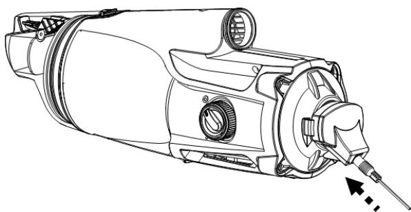
4. Připojte externí adaptér ke zdroji napájení. Jakmile se bazénový vysavač začne nabíjet, kontrolka na externím adaptéru zčervená. Plné kapacity nabití dosáhne za 4–6 hodin. Když je bazénový vysavač téměř plně nabitý, kontrolka se rozsvítí zeleně.
