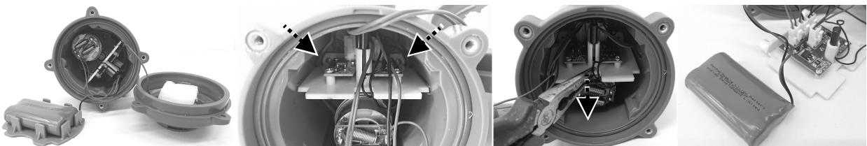
5. Localize o conector central conforme indicado, prima o clipe no conector para puxar para fora. NOTA: Enrole o conector imediatamente com fita isoladora de modo a evitar curto-circuito causado pelo contacto de ambos os terminais do cabo.
