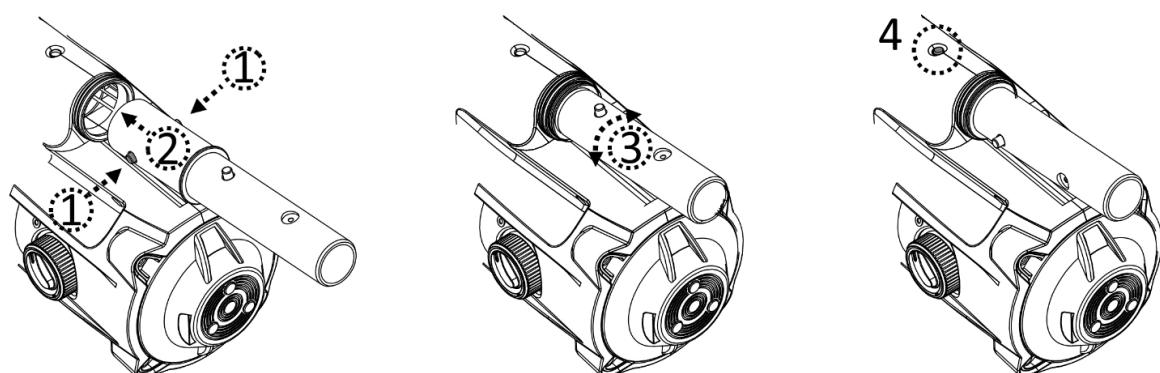
Nasuňte teleskopickou tyč na tyčový konektor. Zatlačte na boční kolíky konektoru a posuňte teleskopickou tyč dále dolů, dokud se kolíky konektoru uvnitř otvorů tyče nezajistí.
