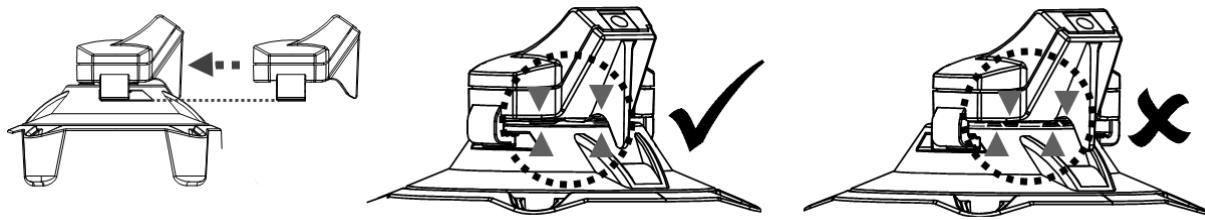
3. Zapojte konektor externího adaptéru do nabíjecího portu na konci nabíjecí základny.
