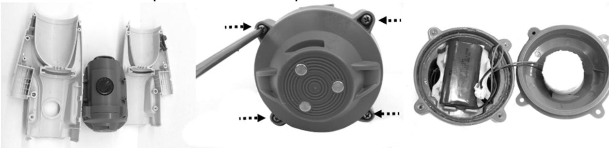
4. Utilizzare un cacciavite Philips per allentare la vite sull'angolo della piastra di supporto diritta. Utilizzare un morsetto per estrarre la piastra per esporre il PCB e i suoi connettori.
