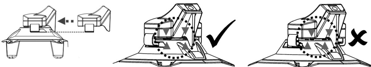
3. Ligue a tomada do adaptador externo à porta de carregamento na extremidade da base de carregamento.
