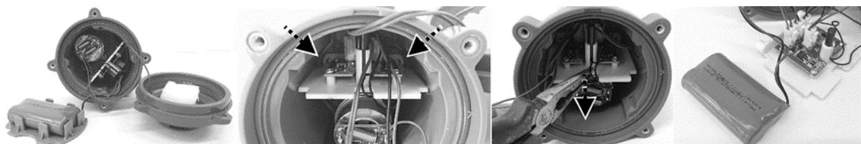
5. Lokalisieren Sie den mittleren Stecker wie gezeigt - drücken Sie den Clip und ziehen Sie ihn heraus. HINWEIS: Umwickeln Sie den Steckverbinder sofort mit Isolierband, um einen Kurzschluss durch den Kontakt der beiden Drahtanschlüsse zu vermeiden.
