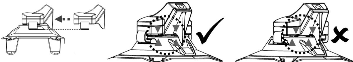
3. Enchufe el conector del adaptador externo en el puerto de carga al final de la base de carga.
