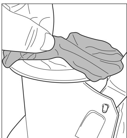
Aava suodatinpussi allasimurin rungon yläaukon päälle. Varmista, että pussin lanka on yläaukon laipan alla.
