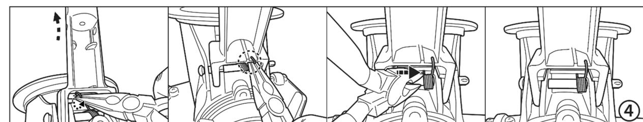
4. Ziehen Sie den Haken mit einer Zange von der Unterseite des Stangenverbinder und befestigen Sie ihn dann wie abgebildet am Stangenverbinder. Führen Sie die gesamte Feder nach rechts.
