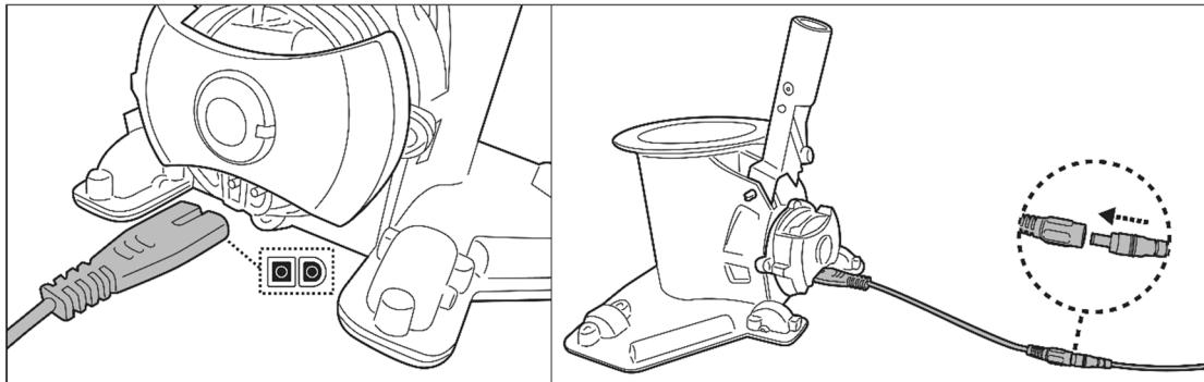
3. Ligue o adaptador externo à fonte de alimentação. A luz indicadora no adaptador externo ficará vermelha quando o aspirador estiver a carregar e verde quando estiver totalmente carregado. Carregue-o durante 5 a 6 horas para um melhor desempenho.
