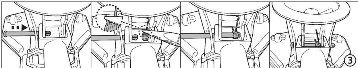
3. Вставьте штифт с одного конца и поместите пружину, как показано, с помощью пары плоскогубцев. Убедитесь, что крючок находится сверху, а другой конец установлен под уступом, как показано на рисунке. Выровняйте и вставьте штифт до упора через отверстие для пружины и противоположное отверстие.
