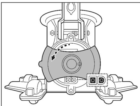
2. Allineare e collegare la cavo di ricarica alla porta di ricarica. **ATTENZIONE!** Assicurarsi di non invertire la cavo di ricarica e assicurarsi che sia la spina che la porta di ricarica siano pulite e asciutte prima di caricarle. **SUGGERIMENTI:** usa un batuffolo di cotone per asciugare la porta di charging e i perni. Collegare la spina del cavo dell'adattatore esterno alla porta del cavo di ricarica.
