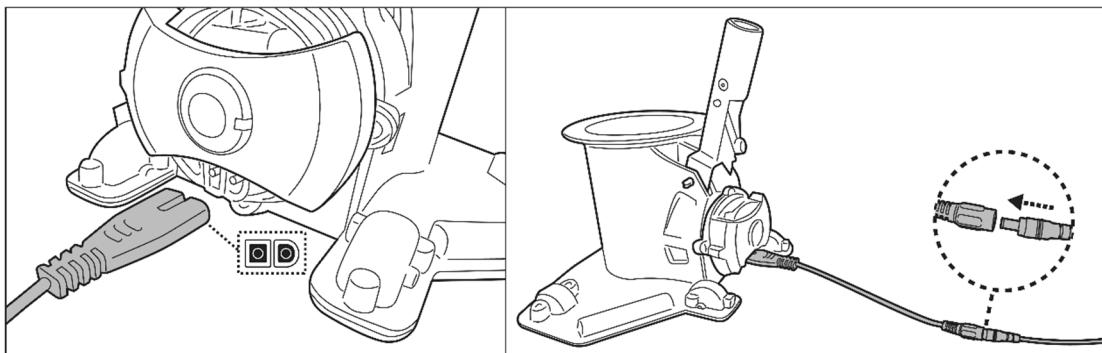
3. Schließen Sie den externen Adapter an die Stromquelle an. Die Anzeigelampe am externen Adapter leuchtet rot, wenn das Vakuum aufgeladen wird, und grün, wenn es vollständig aufgeladen ist. Laden Sie es 5-6 Stunden lang auf, um die beste Leistung zu erzielen.
