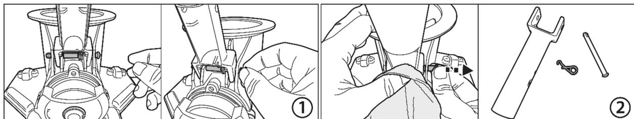
1. Afferrare l'estremità superiore rotonda del perno. Usare un paio di pinze per aiutare la rimozione, se necessario.
