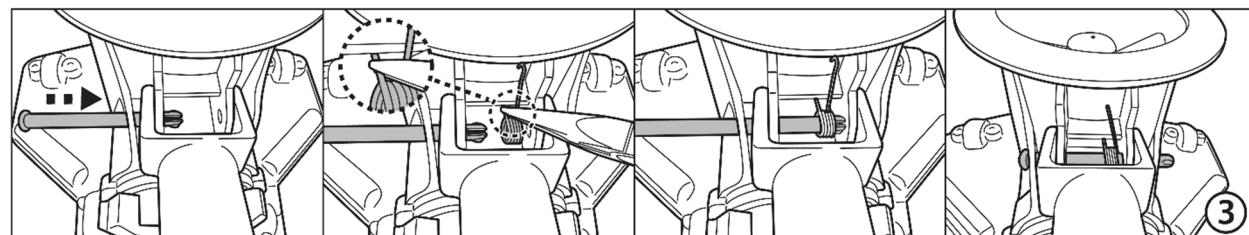
3. För in stiftet från ena sidan och placera fjädern som på bilden med hjälp av en tång. Försäkra dig om att kroken är på ovansidan och att den andra änden installeras under bänken, som på bilden. Håll stiftet i rätt höjd och för in det hela vägen genom fjädringshålet och det motsatta hålet.
