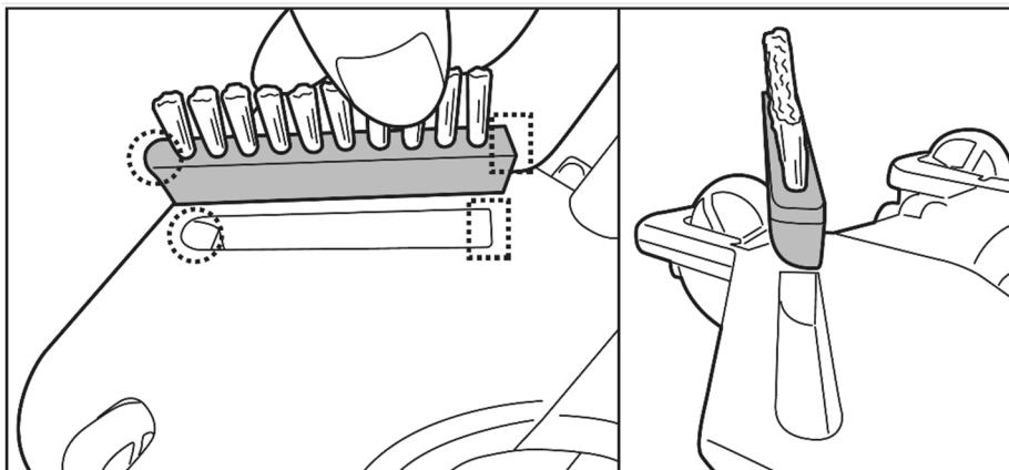
Um die Bürste abzunehmen, führen Sie die Spitze eines kleinen Schraubendrehers in die Eckaussparung ein und drücken Sie die Bürste nach oben.
