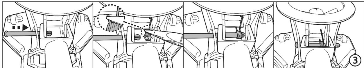
3. Insira o pino a partir de uma extemidade e coloque a mola conforme indicado com a ajudar a um alicate. Certifique-se de que o gancho está no topo e que a outra extremidade está instalada debaixo da bancada conforme indicado. Alinhe e insira o pino através do orifício da mola e do orifício oposto.
