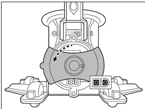
2. Kohdista ja työnnä latauskaapeli latausliittimeen. **VAROITUS!** Älä lataa latauskaapelia väärinpäin ja varmista, että sekä latauskaapeli että latausliitin ovat puhtaat ja kuivat ennen lataamista. VINKKI: kuivaa latausliitin ja sen nastat vanupuikolla. Liitä ulkoisen laturin kaapelin pistoke latauskaapelin liittimeen.
