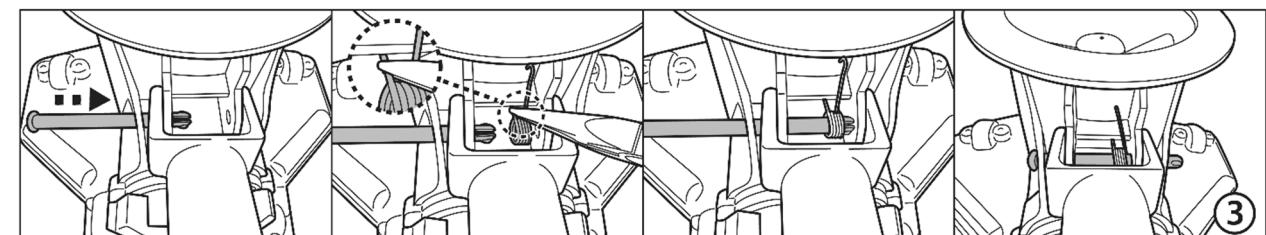
3. Inserire il perno da un'estremità e posizionare la molla come mostrato con l'aiuto di un paio di pinze. Assicuratevi che il gancio sia in alto e che l'altra estremità sia installata sotto il banco come mostrato. Allineare e inserire il perno fino in fondo attraverso il foro della molla e il foro opposto.
