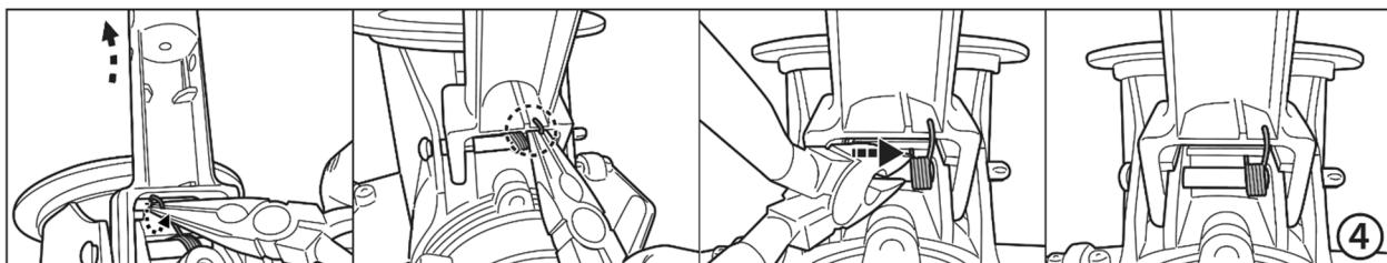
4. Utilize um alicate para puxar o gancho do fundo do conector e depois fixe-o ao conector conforme indicado. Mova toda a mola para a direita.
