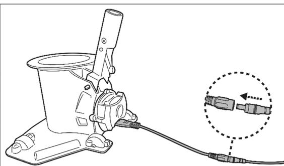
3. Enchufe el adaptador externo a una toma de corriente. El indicador luminoso del adaptador externo permanecerá en rojo mientras la aspiradora se esté cargando y pasará a verde una vez completada la carga. Cargue el aspirador durante 5-6 horas para optimizar su rendimiento.
