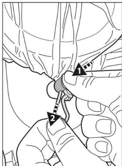
Während Sie die Schnur halten, drücken Sie auf den Schnurbefestigung und schieben Sie ihn unter den Flansch.
