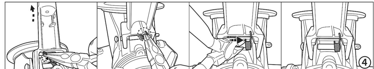
4. Usare un paio di pinze per tirare il gancio dalla parte inferiore del connettore, poi fissarlo sul connettore come mostrato. Spostare l'intera molla a destra.
