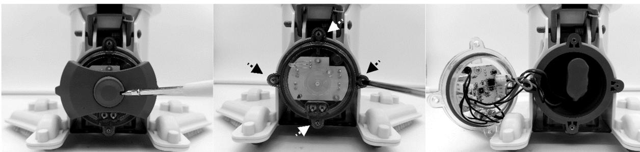
2. Remova a bateria da unidade e localize o conector do cabo da bateria. Prima o clipe do conector para o puxar para fora. NOTA: Enrole o conector imediatamente com fita isoladora de modo a evitar qualquer curto-circuito causado pelo contacto de ambos os terminais de cabo.
