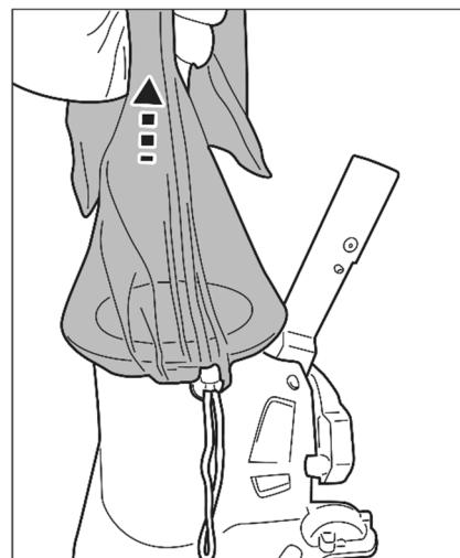
Heben Sie den Beutel an, um sicherzustellen, dass er vollständig gesichert ist, bevor Sie den Pool-Sauger in Wasser einsetzen.
