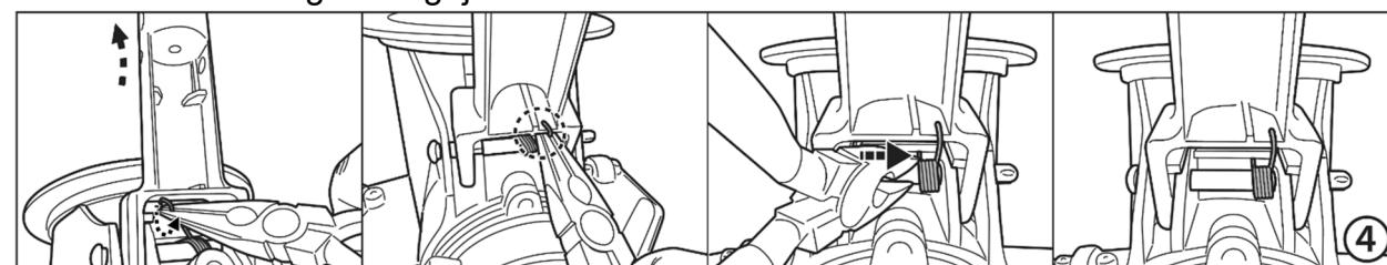
4. Con ayuda de unos alicates, tire del gancho de la parte inferior del conector para fijarlo al conector, tal como se muestra en las imágenes. Desplace el muelle hacia la derecha.
