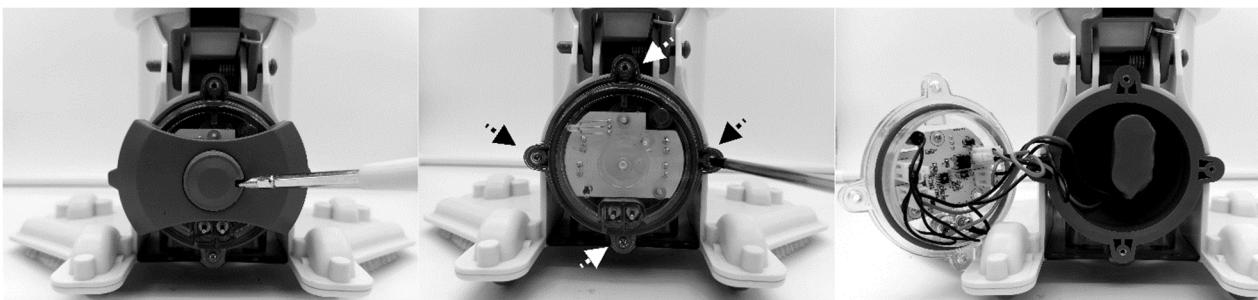
2. Извлеките аккумулятор из устройства и найдите разъем кабеля аккумулятора. Нажмите на зажим разъема, чтобы вытащить его. **ПРИМЕЧАНИЕ:** Немедленно оберните контакты изолентой, чтобы избежать короткого замыкания, вызванного контактом обеих клемм проводов.
