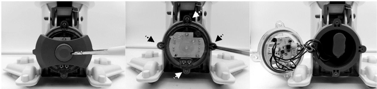
2. Rimuovere la batteria dall'unità e individuare il connettore del cavo della batteria. Per staccare il cavo di collegamento della batteria, premere sulla clip del connettore per estrarlo. NOTA: avvolgere immediatamente il connettore con nastro isolante per evitare cortocircuiti causati dal contatto di entrambi i terminali del filo.
