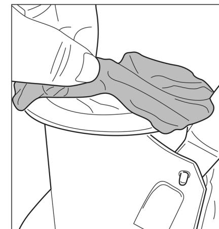
Espalhe o saco do filtro sobre a abertura superior do corpo principal do aspirador de piscinas. Certifique-se de que o cabo do saco é colocado debaixo da flange da abertura superior.
