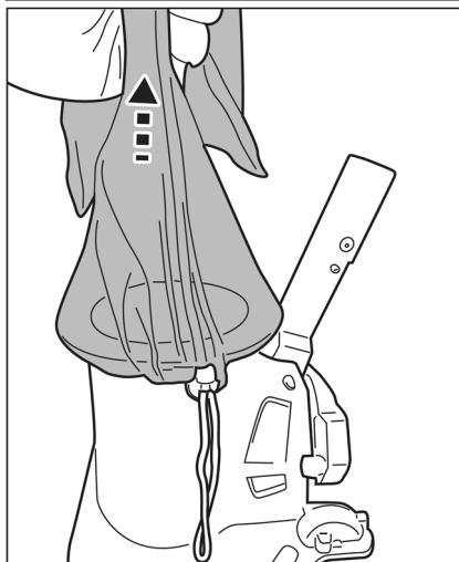
Løft posen opp for å sikre at den er fullstendig festet, før bassengstøvsugeren settes ut i vann.
