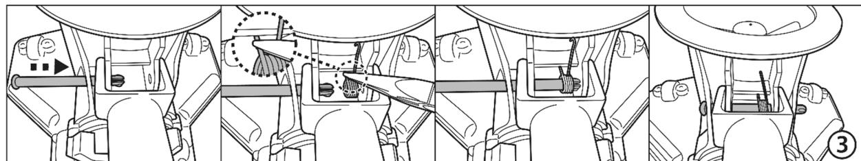
3. Führen Sie den Stift von einem Ende aus ein und setzen Sie die Feder wie abgebildet mit Hilfe einer Zange ein. Stellen Sie sicher, dass sich der Haken oben befindet und das andere Ende wie abgebildet unter der Schiene installiert ist. Richten Sie den Stift aus und stecken Sie ihn ganz durch das Federloch und das gegenüberliegende Loch.
