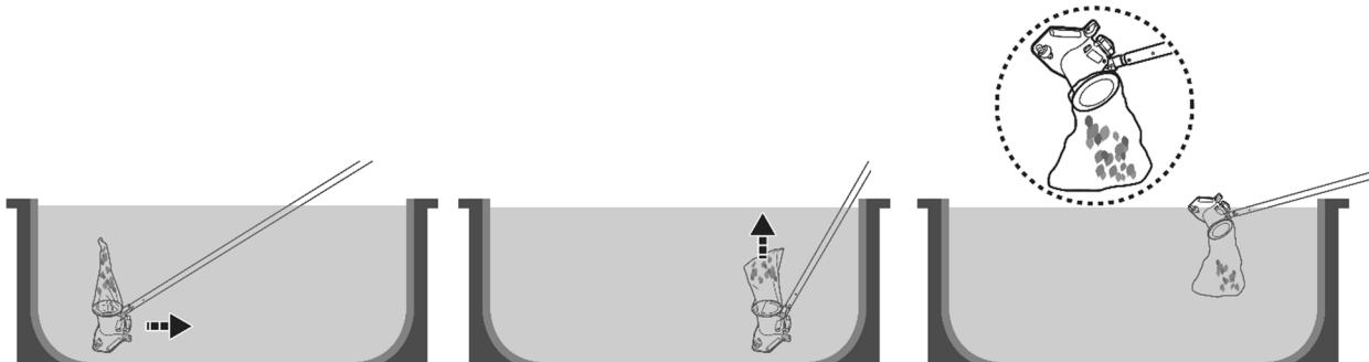
3. Lave o aspirador de piscinas com água fresca após cada utilização. NÃO utilize qualquer detergente agressivo.
