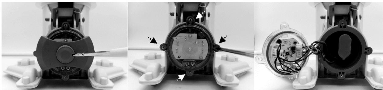
2. Entfernen Sie die Batterie aus dem Gerät und suchen Sie das Batterieanschlusskabel. Drücken Sie zum Abziehen des Batterieanschlusskabels auf den Clip des Steckers, um ihn herauszuziehen. **HINWEIS:** Wickeln Sie den Stecker sofort mit Isolierband um, um Kurzschlüsse durch den Kontakt beider Kabelklemmen zu vermeiden.
