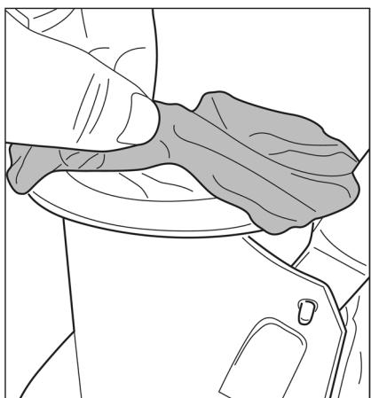
Bre filterposen utover åpningen øverst på hoveddelen av bassengstøvsugeren. Sørg for at snoren på posen er plassert under kanten på åpningen øverst.
