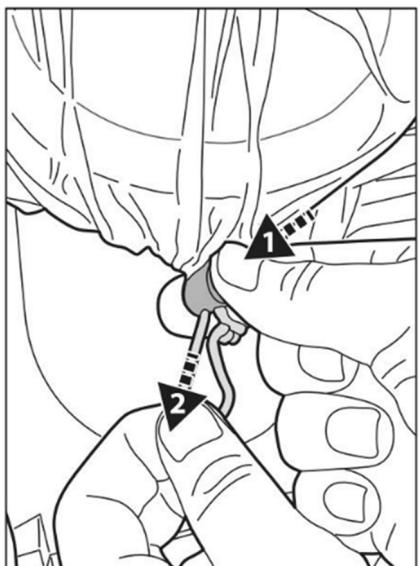
Con il cavo in mano, premere sul dispositivo di fissaggio del cavo e spingerlo sotto la flangia.
