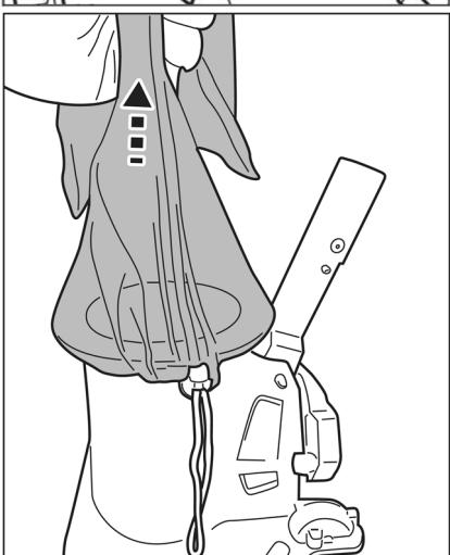
Поднимите мешок, чтобы убедиться, что он хорошо закреплен, прежде чем опускать пылесос для бассейна в воду.
