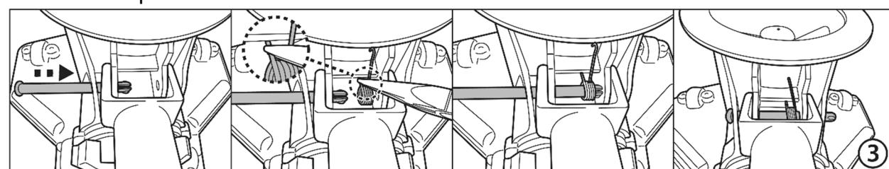
3. Inserte el pasador por un lado y con la ayuda de unos alicates coloque el muelle tal como se muestra en las imágenes. Asegúrese de que el gancho queda arriba y que el otro extremo queda por debajo de la base. Alinee e inserte el pasador a través del muelle hasta llegar el agujero del otro lado.
