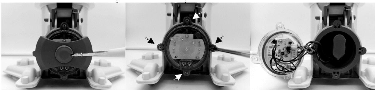
2. Verwijder de accu uit het toestel en zoek de connector van de accukabel. Om de batterijverbindingsdraad los te maken, drukt u op de clip van de connector om deze eruit te trekken. **OPMERKING:** Wikkel de connector onmiddellijk met isolatietape in om kortsleuteling door het contact van beide draadaansluitingen te voorkomen.
