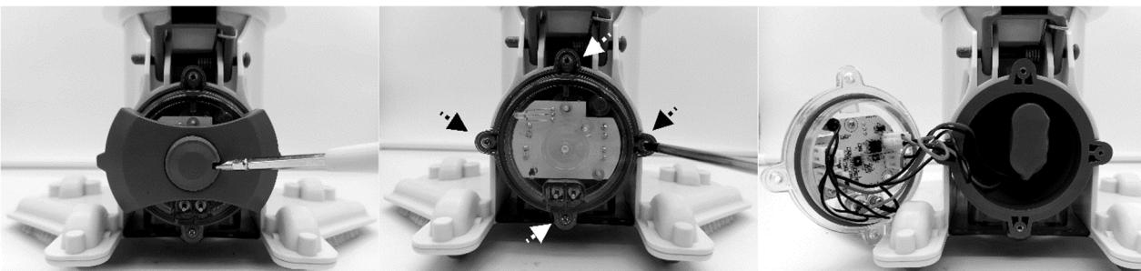
2. Plocka bort batteriet från enheten och lokalisera batterisladdens kontakt. Tryck på kontaktens klämma för att dra ut den. ANMÄRKNING: Linda omedelbart isoleringstejp runt kontakten för att undvika kortslutning orsakad av att de två anslutningsterminalerna kommer i kontakt med varandra.
