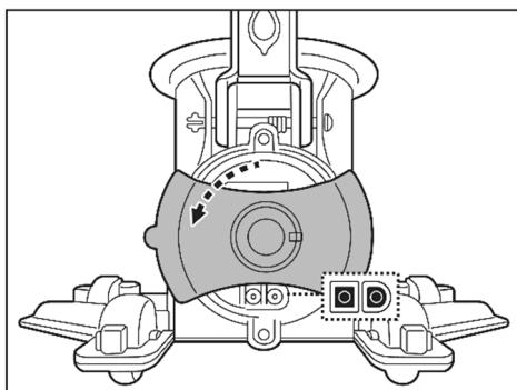
2. Alinee e inserte el cable de carga en el puerto de carga. **ADVERTENCIA:** Asegúrese de no invertir el cable de carga y de que tanto el enchufe como el puerto estén limpios y secos antes de la carga. CONSEJO: Utilice un bastoncillo de algodón para secar el puerto de carga y las clavijas. Conecte el enchufe del cable del adaptador externo al puerto del cable de carga.
