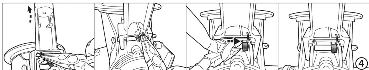
4. С помощью плоскогубцев вытяните крючок из нижней части соединительной вставки, затем закрепите его на вставке, как показано. Переместите всю пружину вправо.
