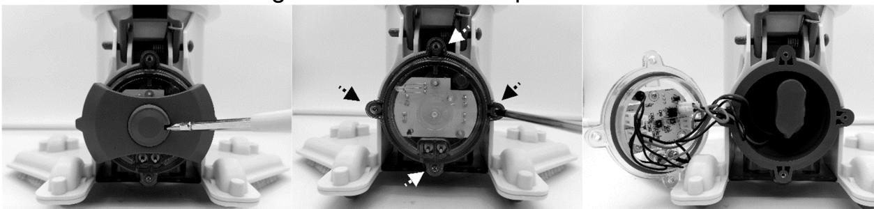
2. Extraiga la batería del compartimento y coloque el conector del cable de la batería. Para soltar el cable de conexión de la batería, presione el clip del conector y tire de él. NOTA: Envuelva el conector inmediatamente con cinta aislante para evitar que los terminales de ambos cables entren en contacto y se produzca un cortocircuito.
