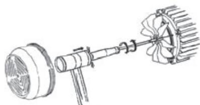
Controllare che l'albero della pompa ruoti liberamente.
