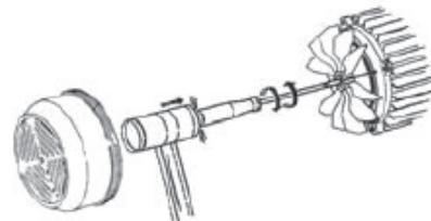
Verifique se o sentido de rotação do motor coincide com o indicado na placa de características (a ventoinha deve rodar, olhando pela parte traseira do motor, no SENTIDO DIRECTO). Se a bomba for trifásica e observarmos que o sentido de rotação é incorrecto, devem-se inverter duas fases de alimentação do quadro de protecção.
